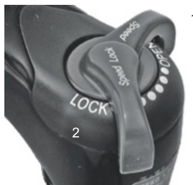
Figura 76: Regulador de niveles de presión Suntour con las posiciones OPEN (1) y LOCK (2)
