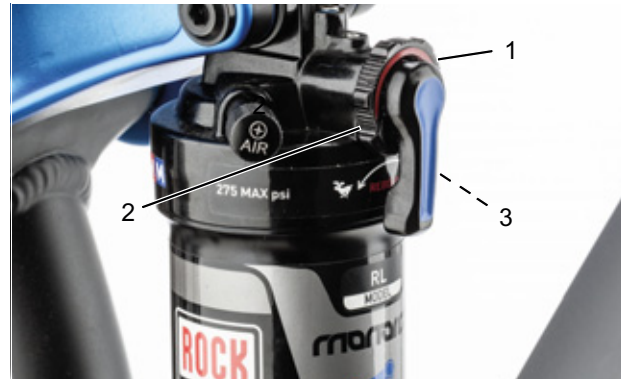
Figura 79: Ajuste de la dureza del amortiguador de niveles de tracción en la rueda de ajuste (1) del amortiguador de la horquilla trasera
