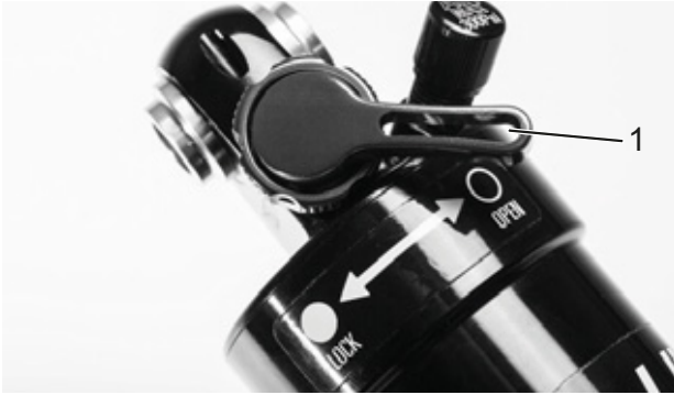
Figura 77: Regulador de niveles de presión Suntour abierto (1)
