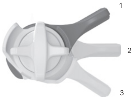
Figura 74: Regulador de niveles de presión FOX en el amortiguador de la horquilla trasera con las posiciones ABIERTO (1), MEDIO (2) y DURO (3)
