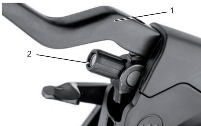
Illustration 76 : Levier de frein (1) du frein de jante à actionnement hydraulique avec vis de réglage (2)
