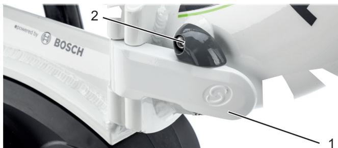
**Illustration 26 :** Cadre, avec levier de serrage du cadre fermé (1) et levier de blocage du cadre fermé (2)
