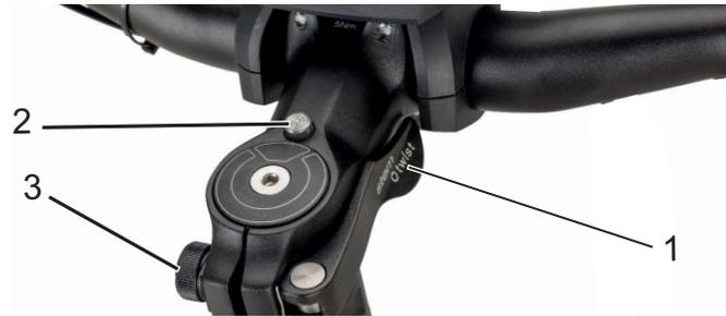
Illustration 18 : Potence, modèle II avec levier de serrage (1), bouton de déblocage (2) et écrou moleté (3)
