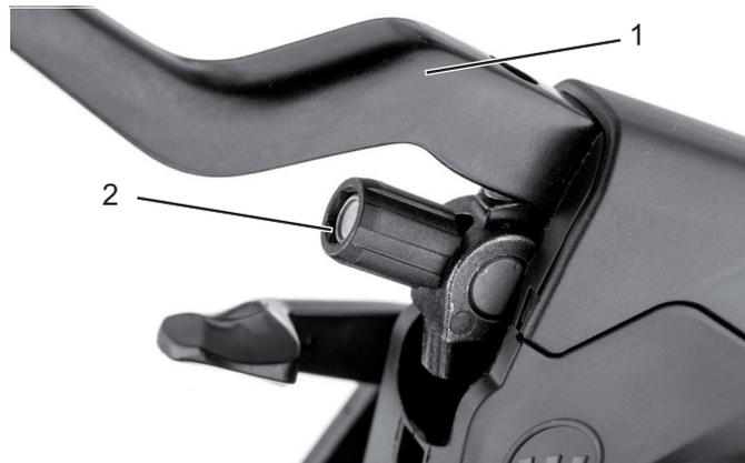
**Illustration 35 :** Levier de frein (1) du frein de jante à actionnement hydraulique avec vis de réglage (2)
