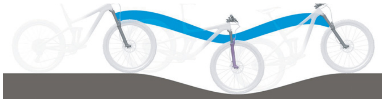
Figura 60: comportamento di marcia ottimale su un terreno con dossi
