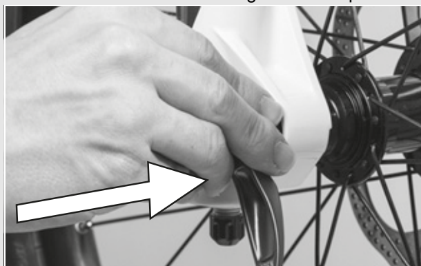
Figura 30: Inserimento del bloccaggio rapido
