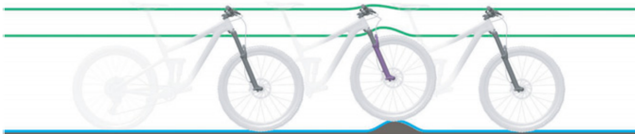
Figura 61: comportamento di marcia ottimale su un terreno con asperità
