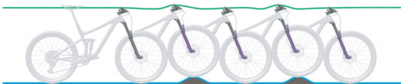
Figura 42: Comportamento di marcia ottimale della forcella
