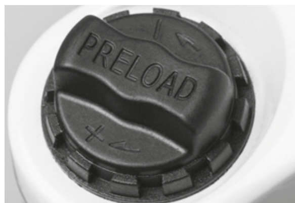
Figura 40: Manopola di regolazione della SAG sulla corona della forcella ammortizzata
