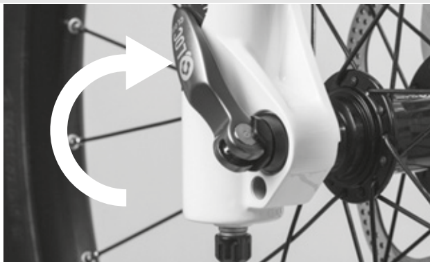
Figura 32: Chiusura del bloccaggio rapido
