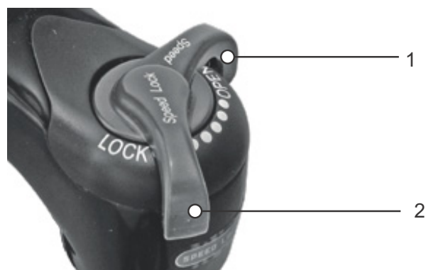
Figura 62: Ammortizzatore a stadi di pressione Suntour in posizione aperta (1) e chiusa (2)
