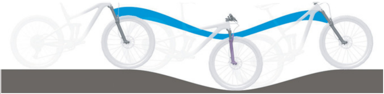
Figura 74: Sospensione della forcella ammortizzata troppo morbida in salita
