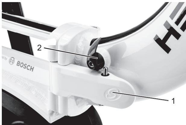
Abbildung 83: Geschlossener (1) und geöffneter (2) Rahmen-Sicherungshebel
