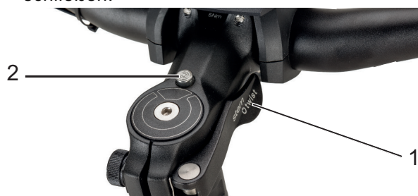
Abbildung 82: Vorbau, Ausführung II mit Spannhebel des Vorbau-Schnellspanners (1) und Entsperrknopf (2)
