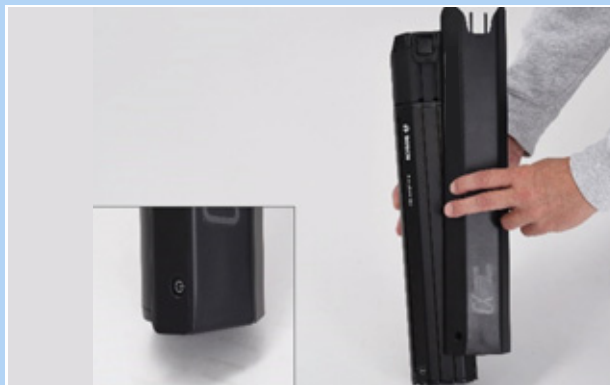
Figura 63: Applicazione della copertura della batteria sulla batteria
