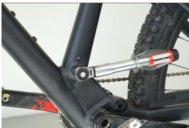
Figura 85: Serraggio dell'asse del cannotto reggisella
