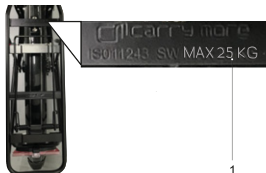
Figura 127: Sul portapacchi è indicata la sua portata massima (1)
