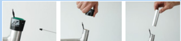
Figura 211: Smontaggio della boccola esterna e del manicotto scorrevole
