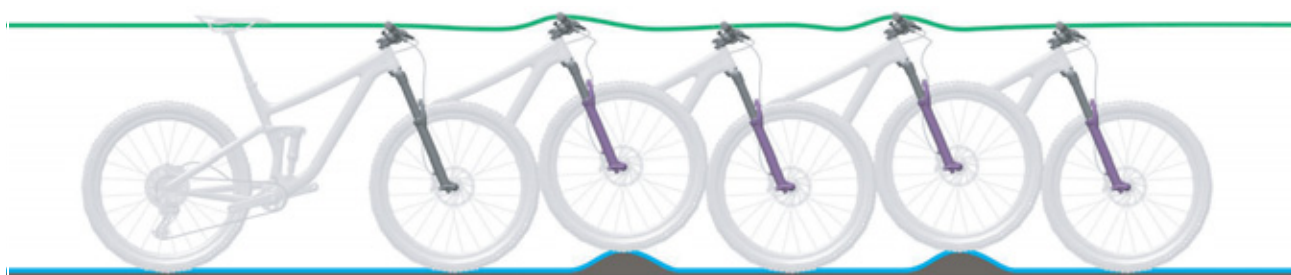
Figura 120: Comportamento di marcia ottimale della forcella
