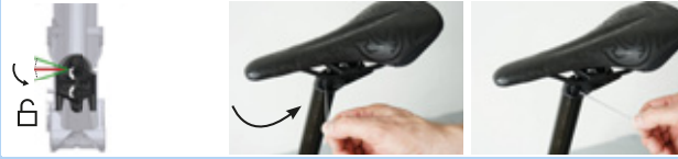
Figura 169: Posizionamento dell'azionamento della regolazione in altezza in posizione orizzontale
