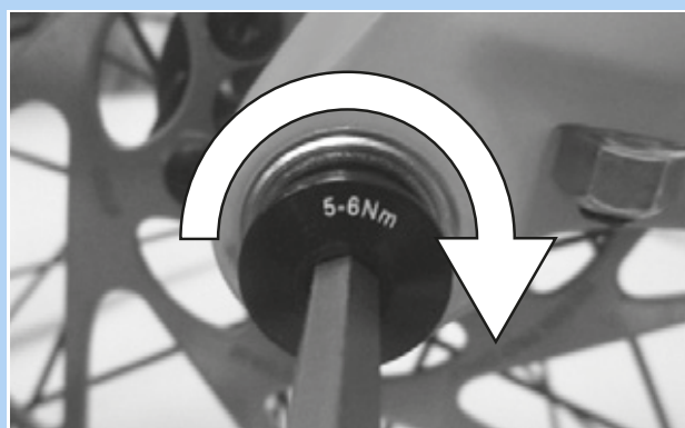
Figura 69: Serraggio della vite di sicurezza
