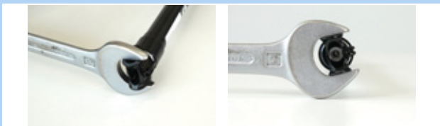
Figura 190: Bloccaggio per impedire la rotazione
