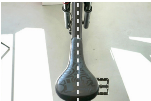
Figura 84: Posizionamento della sella in direzione di marcia
