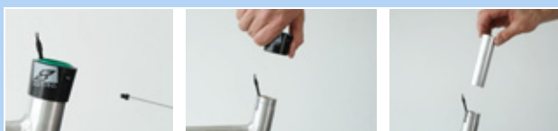
Figura 177: Smontaggio della boccola esterna e del manicotto scorrevole
