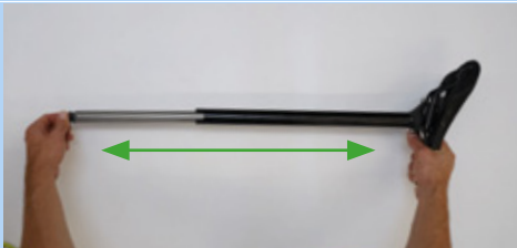
Figura 221: Estrazione completa del tubo del canotto reggisella
