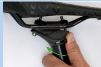
Figura 225: Chiusura della regolazione in altezza
