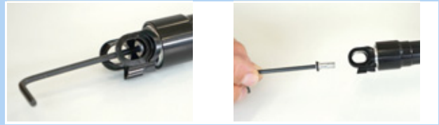
Figura 185: Svitamento del cappuccio della valvola
