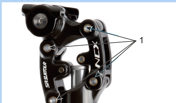
Figura 168: Punti di lubrificazione del cannotto reggisella ammortizzato SR Suntour
