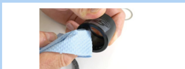
Figura 181: Pulizia della boccola esterna
