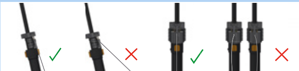
Figura 196: Cavo meccanico corretto ed errato
