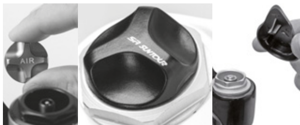
Figura 119: Coperture a vite di diverse versioni
