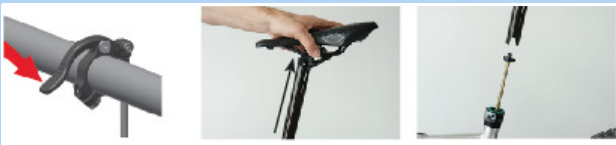
Figura 170: Estrazione del cannotto reggisella
