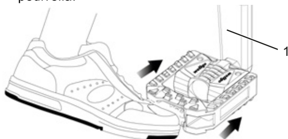
Figura 144: Spinta del pedale contro la pedivella (1)
