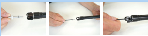
Figura 188: Fissaggio del coperchio della valvola della cartuccia
