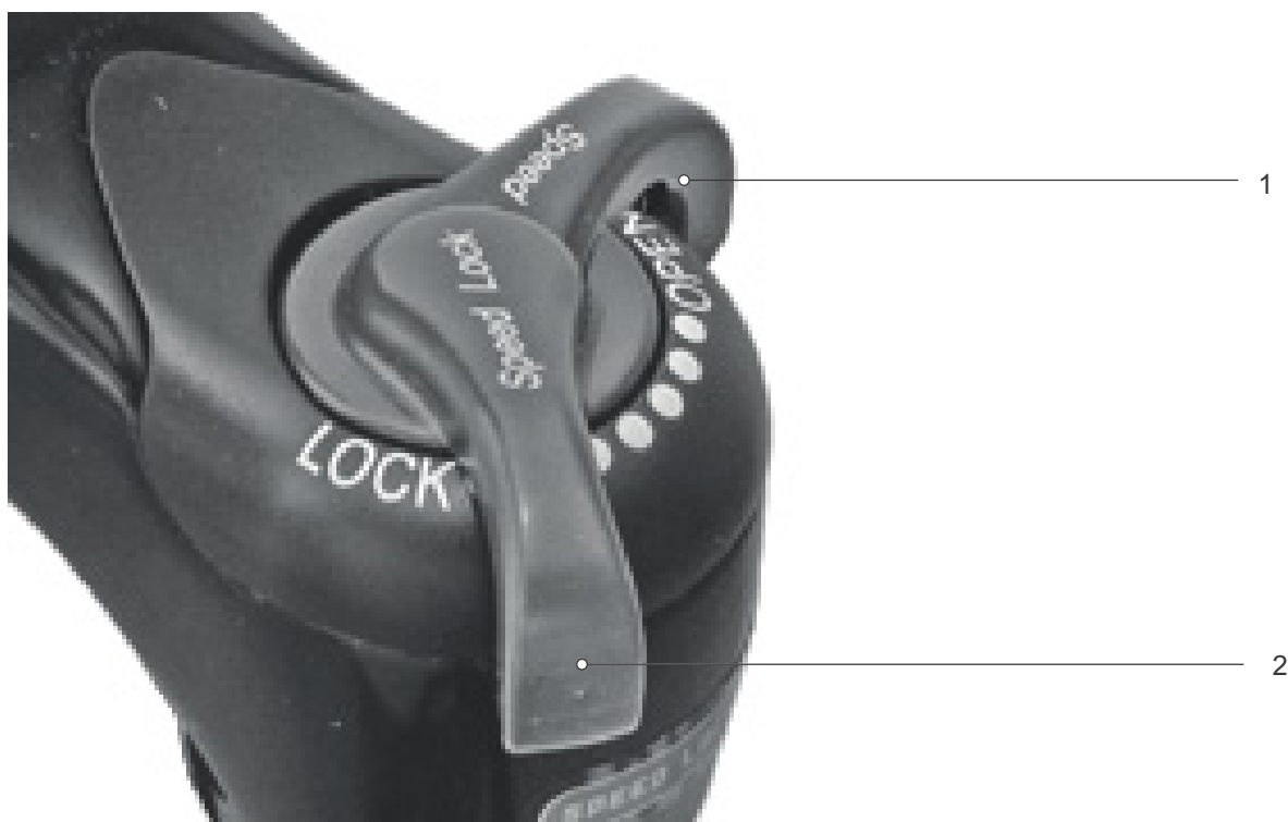
Figura 137: Ammortizzatore a stadi di pressione Suntour in posizione aperta (1) e chiusa (2)
