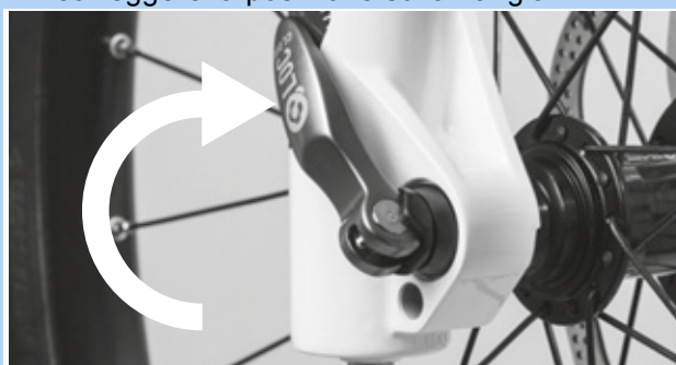
Figura 79: Chiusura del bloccaggio rapido
