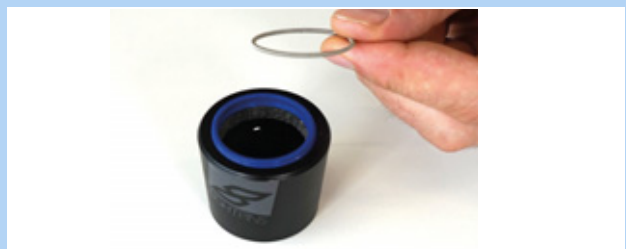
Figura 213: Anello elastico smontato
