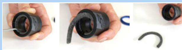
Figura 180: Rimozione dell'anello di feltro
