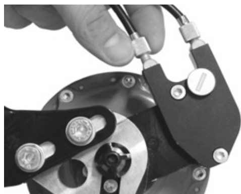
Figura 162: Le versioni del mozzo Rohloff con comando esterno del cambio hanno i regolatori del tensionamento sulla scatola dei cavi situata sul lato sinistro
