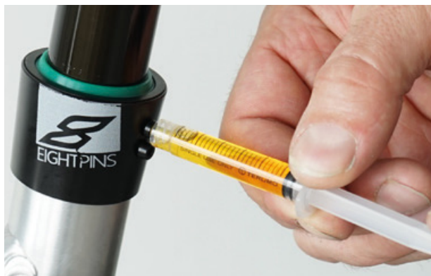
Figura 154: Lubrificazione del tubo del cannotto reggisella
