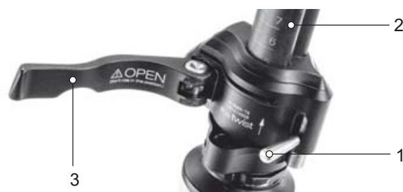
Figura 146: Leva di serraggio (3) del bloccaggio rapido dell'attacco manubrio aperta sull'attacco manubrio (2), versione I, con leva di sicurezza (1) sull'attacco manubrio
