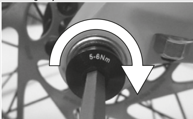
Rysunek 29: Sposób dokręcania śruby zabezpieczającej
