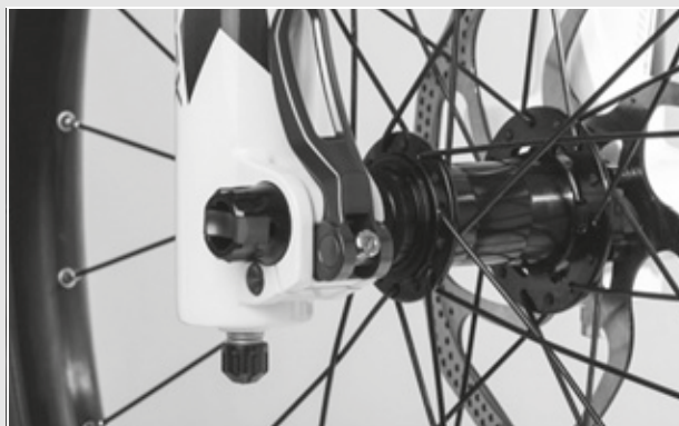
Rysunek 36: Optymalne położenie dźwigni mocującej
