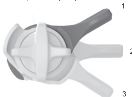
Rysunek 78: Nastawnik dobicia FOX obsługujący tylny amortyzator z pozycjami OTWARTE (1), ŚREDNIE (2) i TWARDE (3)
