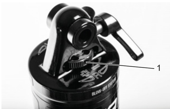
Rysunek 61: Nastawnik odbicia koła Suntour (1) na tylnym amortyzatorze
