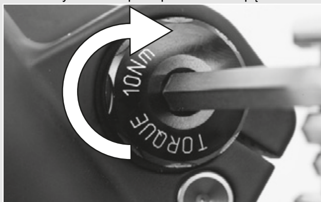
Rysunek 30: Sposób dokręcania włożonej osi
