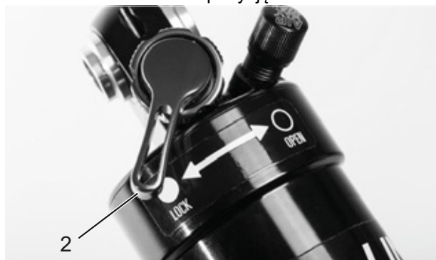
Rysunek 82: Nastawnik dobicia Suntour w pozycji zamkniętej (2)
