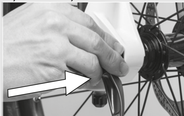
Rysunek 39: Wsuwanie zacisku szybko mocującego
