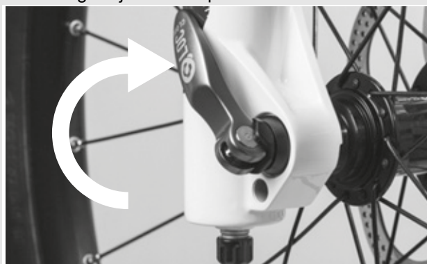
Rysunek 41: Zamykanie zacisku szybko mocującego
