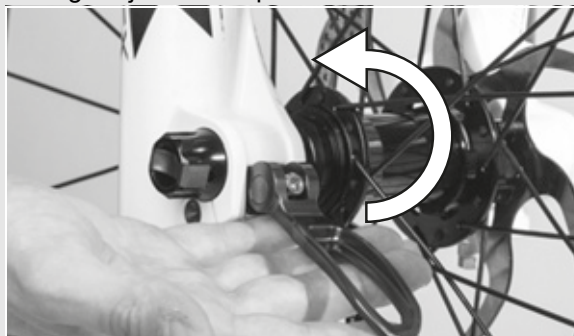
Rysunek 35: Sposób zabezpieczania dźwigni
