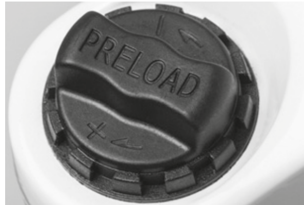
Rysunek 58: Pokrętko regulacyjne ujemnego skoku sprężyny, usytuowane na koronie widelca amortyzowanego
