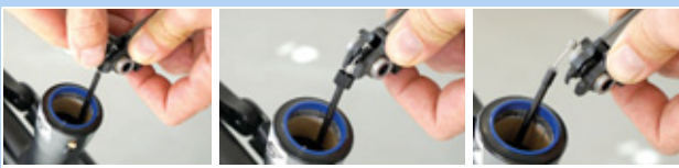
Figura 218: Rimozione del cavo meccanico
