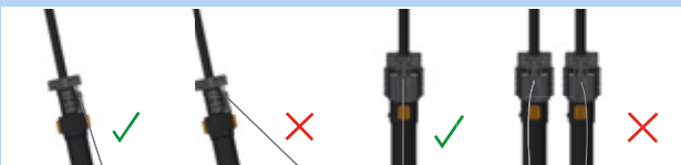
Figura 204: Cavo meccanico corretto ed errato
