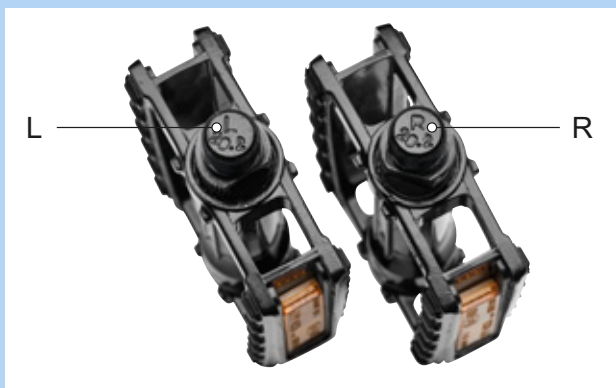
Figura 65: Esempio: identificazione dei pedali
