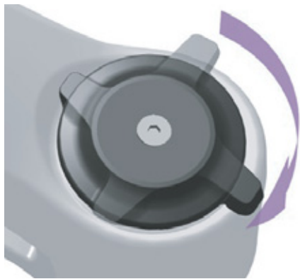
Figura 252: Regolazione più rigida del regolatore dello stadio di compressione
