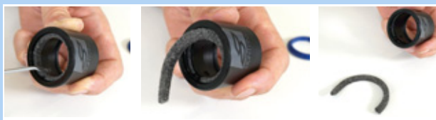
Figura 188: Rimozione dell'anello di feltro
