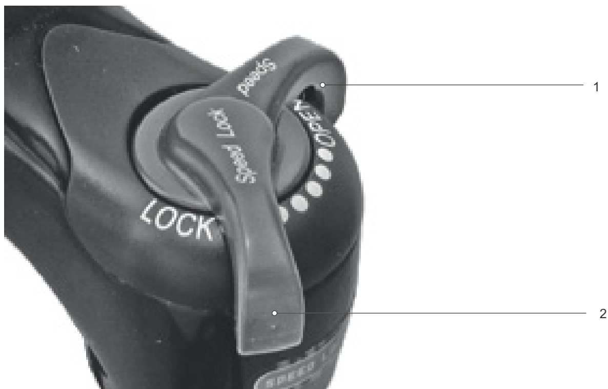
Figura 149: Ammortizzatore a stadi di pressione Suntour in posizione aperta (1) e chiusa (2)
