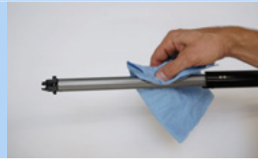
Figura 230: Pulizia della scanalatura di guida longitudinale
