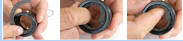
Figura 225: Applicazione dell'anello di feltro
