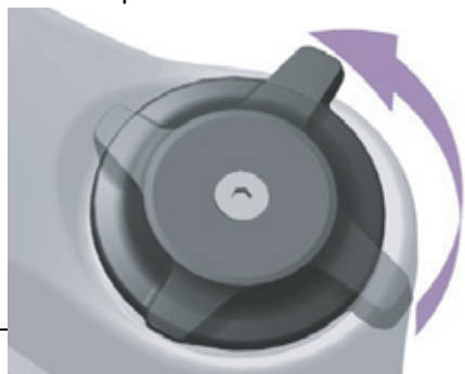
Figura 151: Regolazione più morbida del regolatore dello stadio di compressione
