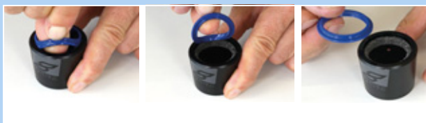
Figura 187: Estrazione del parapolvere
