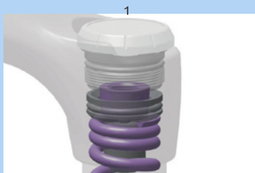
Figura 98: Avvitamento e svitamento dell'anello di regolazione del precarico
