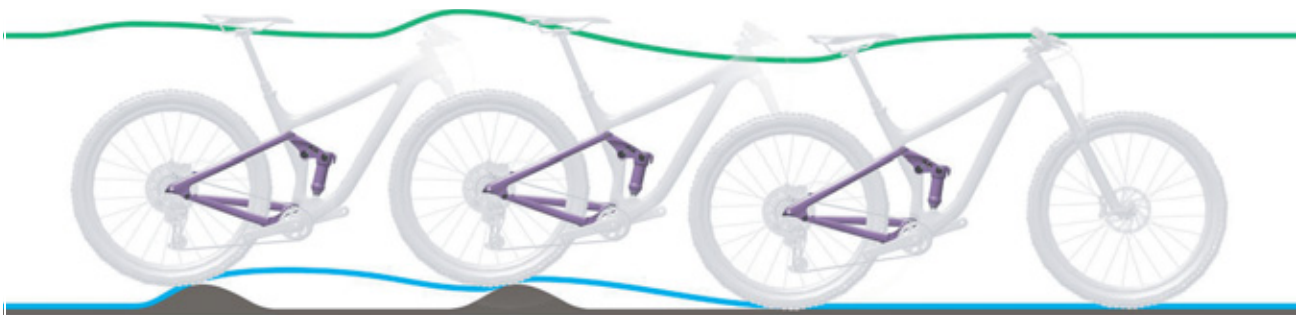
Figura 265: Corsa di estensione troppo lenta dell'ammortizzatore del carro posteriore
