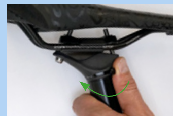
Figura 233: Chiusura della regolazione in altezza
