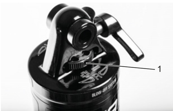
Figura 258: Regolatore del rebound Suntour (1) sull'ammortizzatore del carro posteriore
