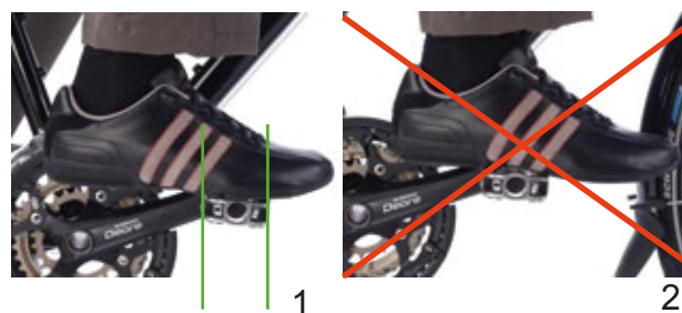
Figura 135: Posizione corretta (1) ed errata (2) del piede sul pedale
