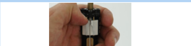
Figura 203: Spinta del cursore di azionamento bianco verso il basso
