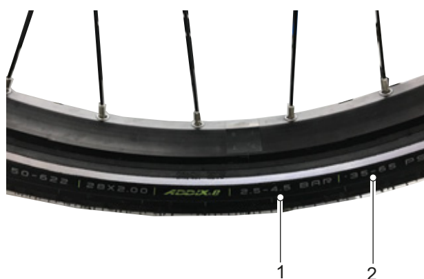
Figura 163: Pressione di gonfiaggio in bar (1) e in psi (2)
