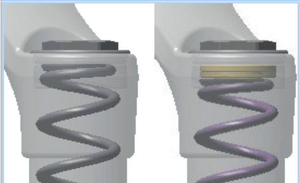
Figura 107: Avvitamento e svitamento dell'anello di regolazione del precarico
