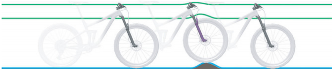
Figura 148: Comportamento di marcia ottimale su un terreno con asperità
