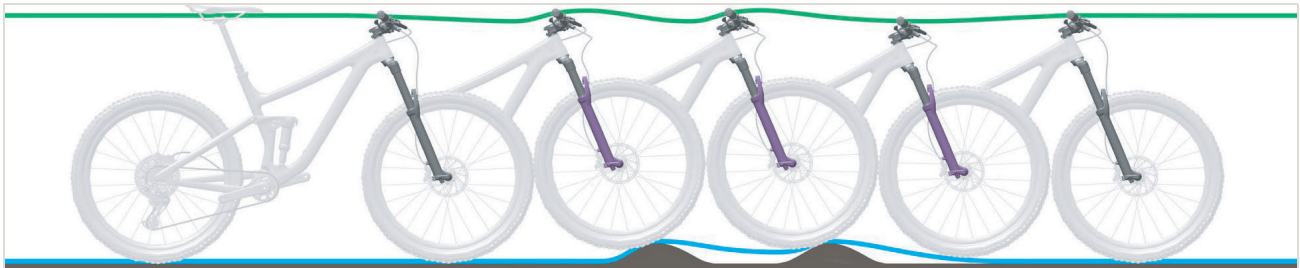
Abbildung 271: Zu langsames Ausfedern der Federgabel
