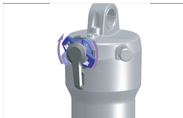
Abbildung 193: Druckstufen-Einsteller härter einstellen
