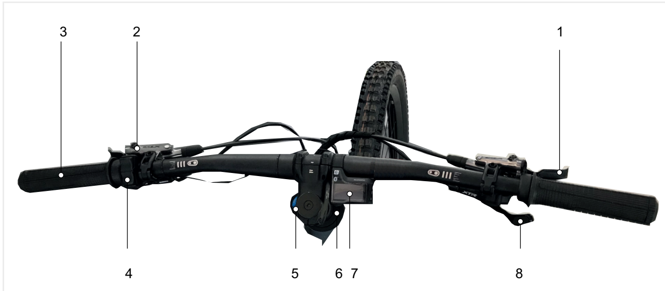
Abbildung 72: Detailansicht Lenker mit SHIMANO SC-E800 Bordcomputer, Beispiel
