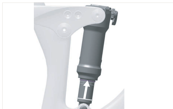
Abbildung 153: O-Ring am Hinterbau-Dämpfer verschieben
