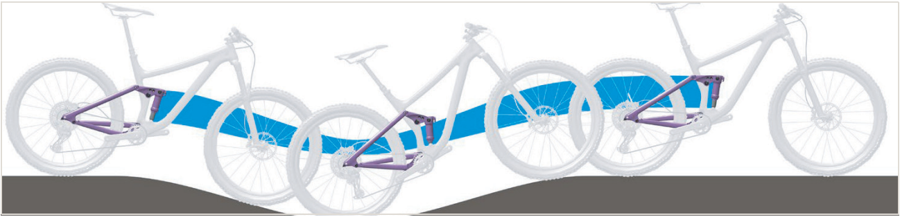
Abbildung 281: Zu weiche Federung des Hinterbau-Dämpfers am Berg
