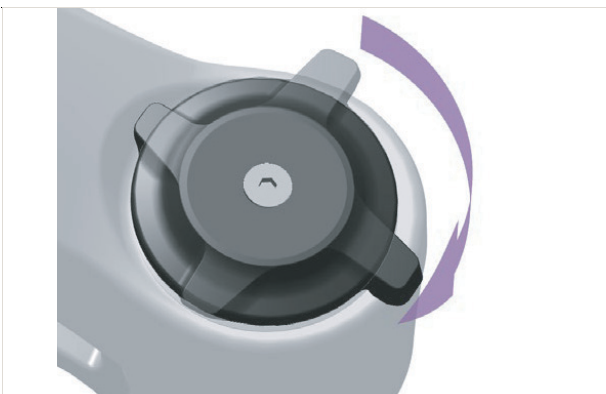
Abbildung 274: Druckstufen-Einsteller härter einstellen
