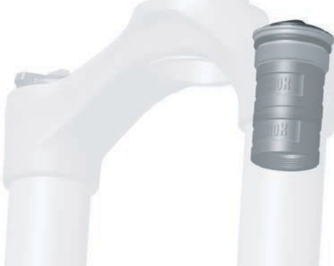
Abbildung 149: Zwei Bottomless Tokens in DebonAir Federung
