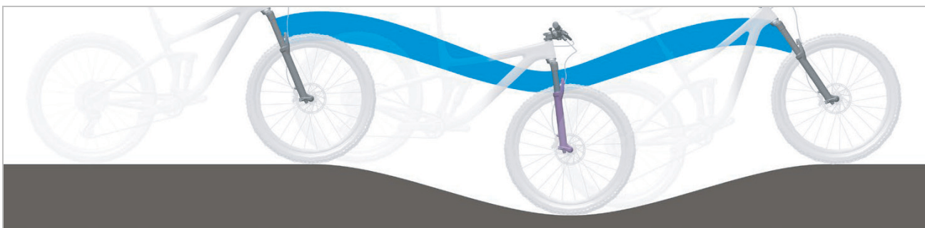
Abbildung 19: Optimales Fahrverhalten der Federgabel im hügeligen Gelände
