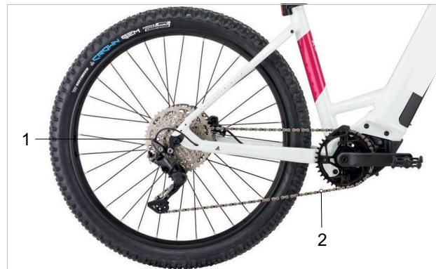
Abbildung 50: Schema Kettenantrieb mit Kettenschaltung
