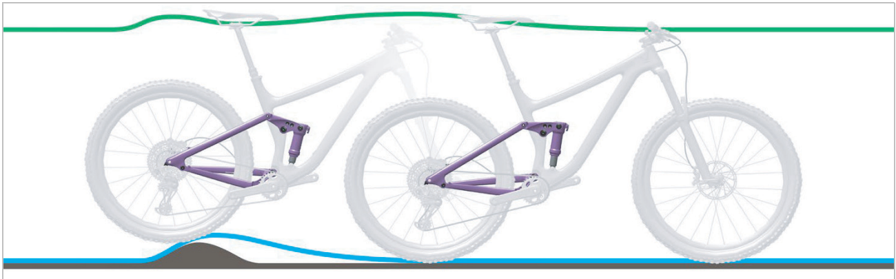
Abbildung 283: Zu harte Dämpfung des Hinterbau-Dämpfers bei Unebenheiten
