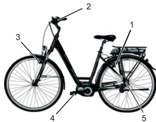
Figur 12: Bremsesystem på en elcykel med frihjulsbremse, eksempel
