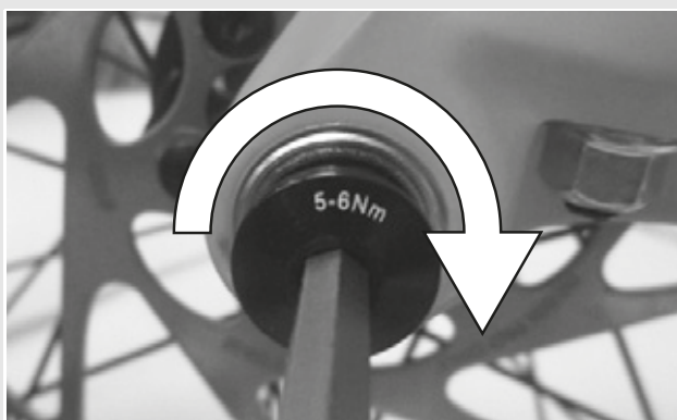
Illustration 23 : Serrer la vis de blocage
