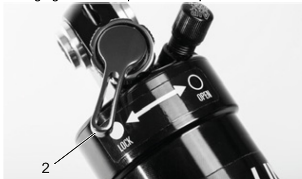
Illustration 66 : Dispositif de réglage de la compression Suntour fermé (2)
