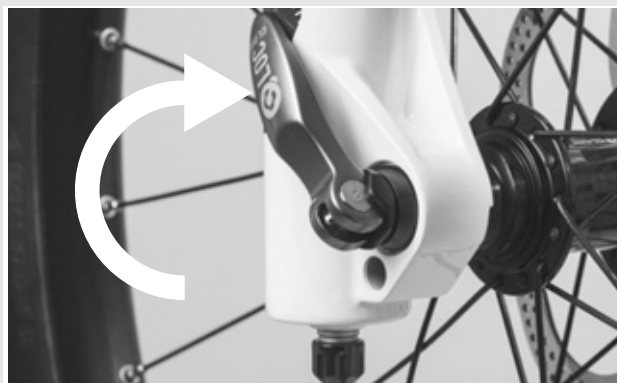
Illustration 35 : Fermer l'attache rapide
