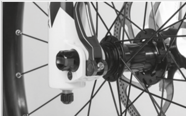
Illustration 30 : Position parfaite du levier de serrage
