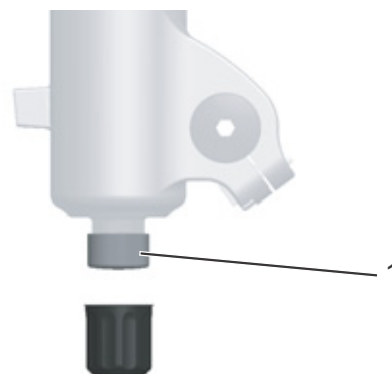
Illustration 54 : Dispositif de réglage de la détente FOX (1) sur la fourche
