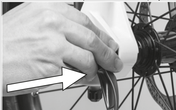
Illustration 33 : Enfoncez l'attache rapide
