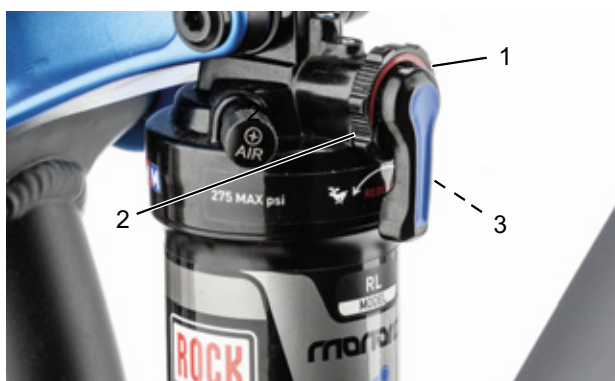
Illustration 67 : Régler la dureté de l'amortisseur de détente (1) de l'amortisseur arrière
