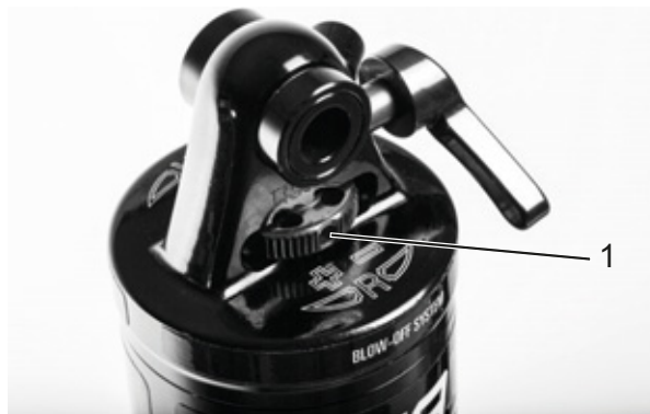
Illustration 55 : Molette de réglage de la détente Suntour (1) sur l'amortisseur arrière
