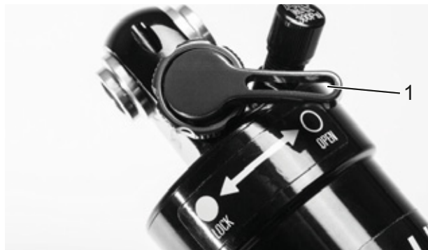
Illustration 65 : Dispositif de réglage de la compression Suntour ouvert (1)
