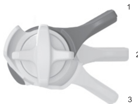
Illustration 62 : Dispositif de réglage de la compression FOX sur l'amortisseur arrière avec les positions OUVERT (1), MOYEN (2) et DUR (3)
