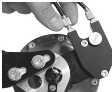
Rysunek 159: Wersje piast Rohloff z zewnętrznym sterowaniem zmiany biegów mają regulator linki na przepustnicy kablowej, która znajduje się po lewej stronie
