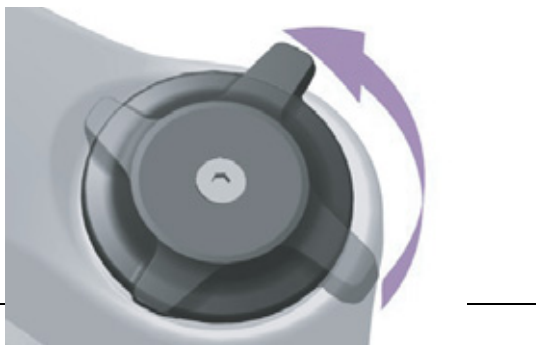
Rysunek 144: Ustawienie nastawnika dobiecia na bardziej miękki tryb pracy
