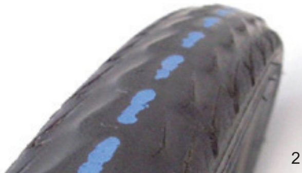
Rysunek 153: Opona bez bieżnika, która jeszcze nadaje się do jazdy (1) i opona z prześwitującą ochroną przed przebicciem (2), którą należy wymienić
