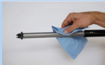
Rysunek 219: Czyszczenie podłużnego rowka prowadzącego
