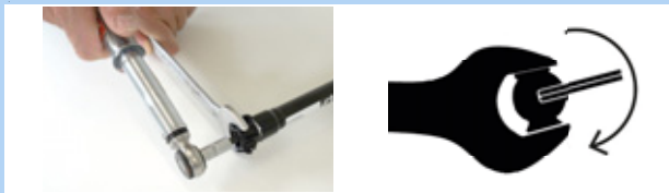
Rysunek 188: Regulacja zgodnie z ruchem wskazówek zegara
