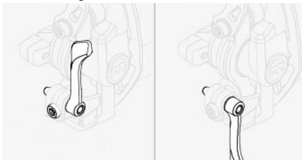
**Illustration 10 : Levier de verrouillage du frein de jante, fermé (1) et ouvert (2)**
