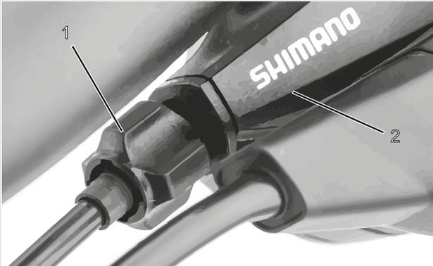
Illustration 85 : Douille de réglage (1) du changement de vitesse à un câble actionné par câble avec boîtier de manette de vitesse (2), exemple
