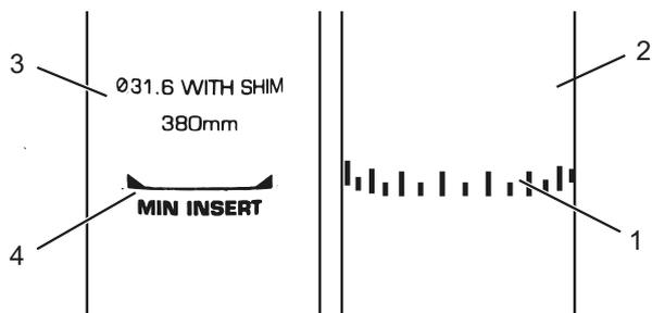
Illustration 49 : Vue détaillée de la tige de selle, exemples de marquage de la profondeur d'insertion minimale
