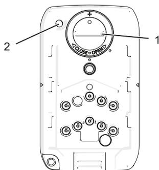
Illustration 18 : Face arrière de l'écran avec compartiment des piles (1) et touche Reset (2)
