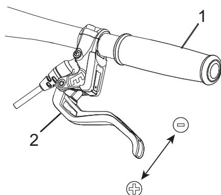
Illustration 55 : Utilisation de la vis de réglage (2) pour ajuster la distance entre le levier de frein et la poignée de guidon (1)
