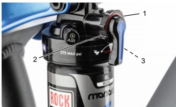
Illustration 78 : Régler la dureté de l'amortisseur de détente (1) de l'amortisseur arrière
