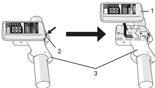
Illustration 68 : Sur l'écran (1), appuyer sur le verrouillage (2) et retirer l'écran du support (3)
