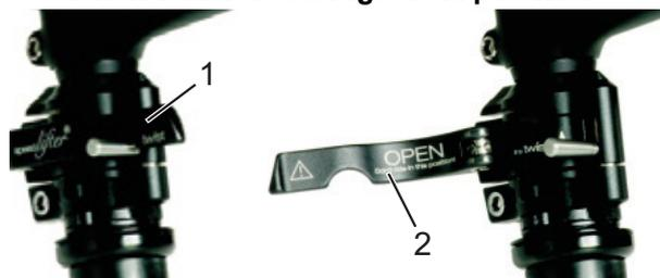
Illustration 52 : Levier de serrage de la potence fermé (1) et ouvert (2), exemple d'un by.schulz speedlifter
