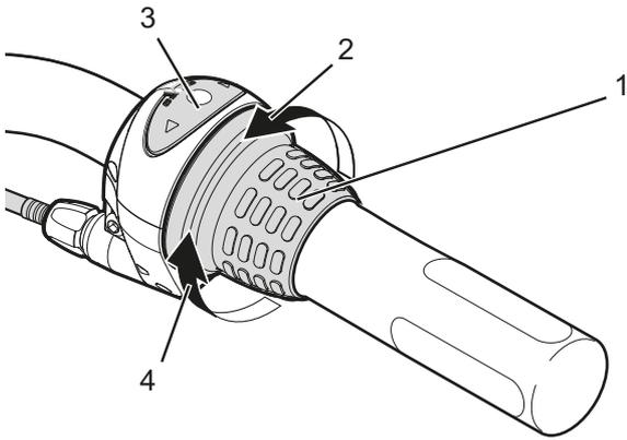
**Illustration 81 : Exemple d'un changement de vitesse Shimano Nexus : Poignée de vitesse rotative (1) du moyeu à vitesses intégrées avec son affichage (3), le sens de rotation pour passer à une vitesse supérieure (2) et le sens de rotation pour une vitesse inférieure (4)**
