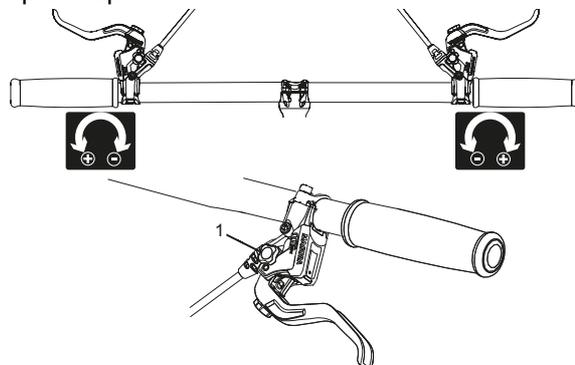
Illustration 54 : Utilisation du bouton rotatif (1) pour le réglage du point de pression
