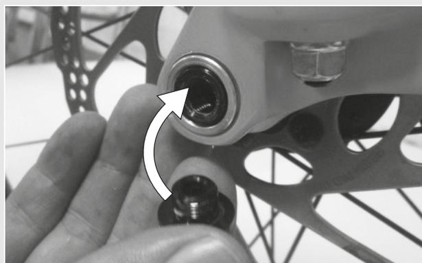
Illustration 28 : Enfoncer le levier d'attache rapide dans l'axe
