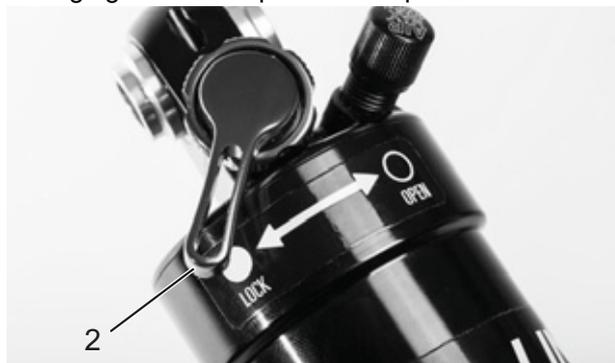
Illustration 77 : Dispositif de réglage de la compression Suntour fermé (2)
