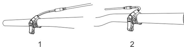
Illustration 50 : Le levier de la tige de selle peut être monté à gauche (1) ou à droite (2) sur le guidon
