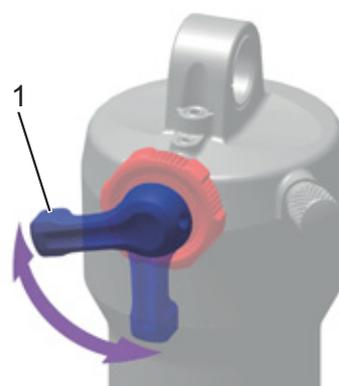
Illustration 79 : Régler la dureté de l'amortisseur de compression sur le levier (1) de l'amortisseur arrière
