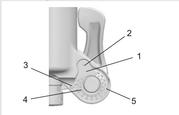
Illustration 44 : Structure de l'attache rapide vue de derrière avec (1) blocage d'écrou d'axe, (2) vis de blocage d'écrou d'axe, (3) flèche indicatrice, (4) valeur de réglage de l'axe et (5) écrou d'axe
