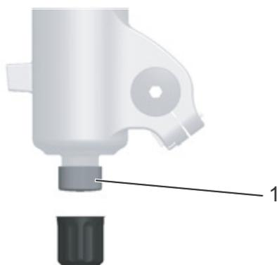
Illustration 59 : Dispositif de réglage de la détente FOX (1) sur l'extrémité de fourche
