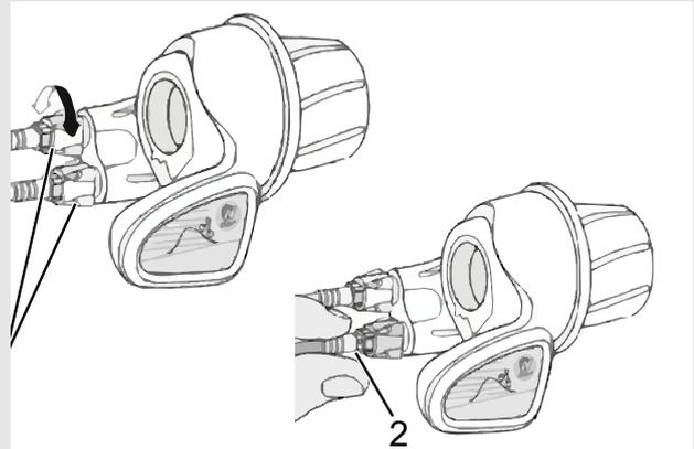
Illustration 87 : Poignée de vitesse rotative avec douilles de réglage (1) et jeu du changement de vitesse (2)
