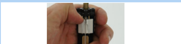
192. ábra: Fehér működtető kapcsoló lefelé tolása
