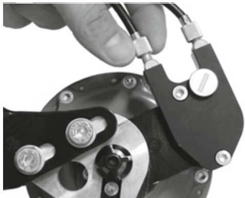
159. ábra: Külső váltóvezérléssel rendelkező Rohloff agyváltozatok húzásbeállítója a kötéldobozon van, ami a bal oldalon található
