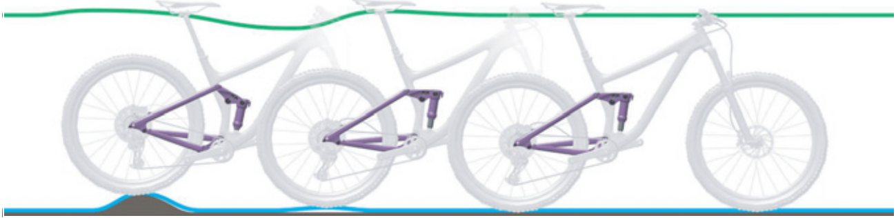
236. ábra: A hátsó lengéscsillapító túl gyors kirugózása
