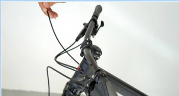
225. ábra: Végsapka beakasztása
