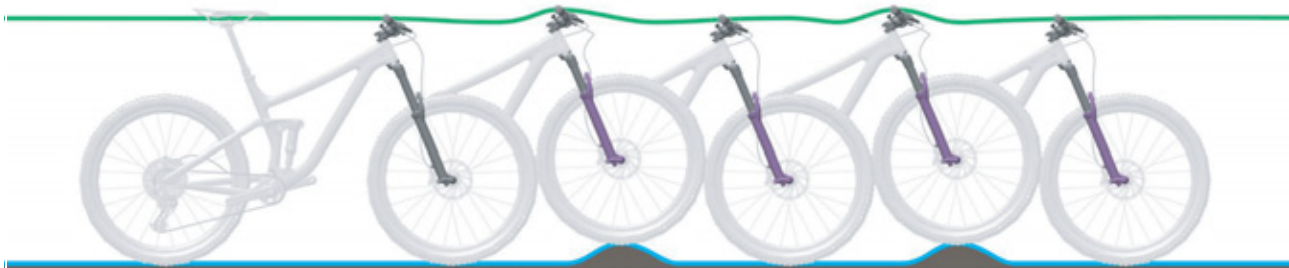
9. ábra: A villa optimális menetviselkedése
