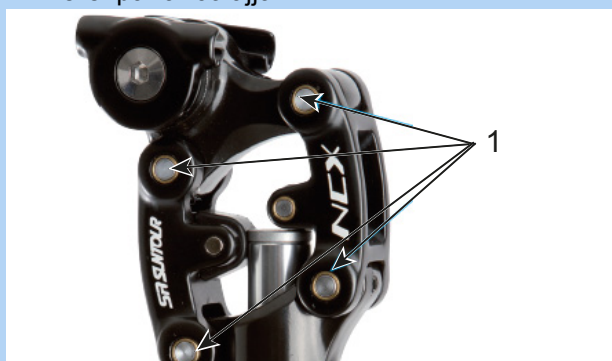
165. ábra: SR kenőpontok Suntour rugós nyeregcső
