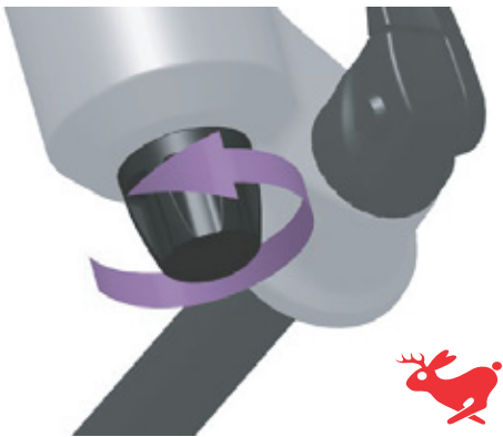
231. ábra: A húzófokozat csavar fordítása a nyúl irányába
