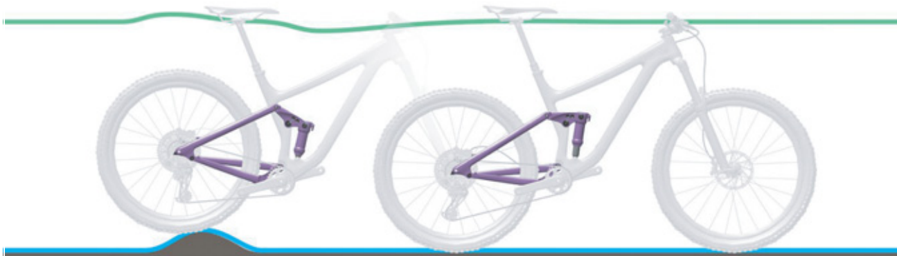
109. ábra: A hátsó lengéscsillapító optimális menetviselkedése egyenetlenségeknél
