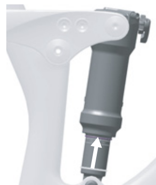
104. ábra: O-gyűrű eltolása a hátsó lengéscsillapítón
