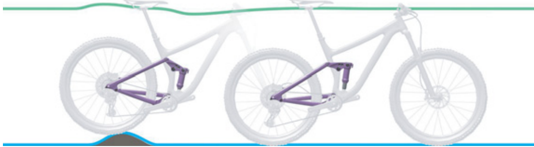
18. ábra: A hátsó lengéscsillapító optimális menetviselkedése egyenetlenségeknél
