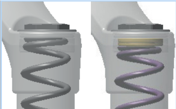
89. ábra: Előfeszítés-beállítógyűrű befelé és kifelé forgatása
