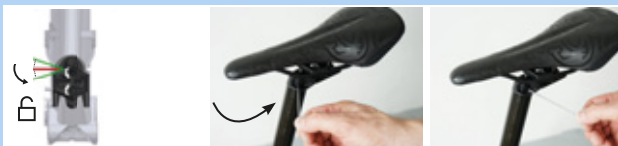
166. ábra: A magasságállító működtető beállítása „nyitott” állásba
