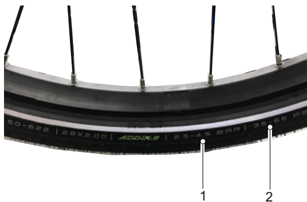
152. ábra: Guminyomás bar-ban (1) és psi-ben (2)
