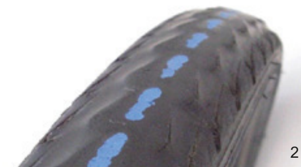
153. ábra: Profil nélküli gumiabroncs, amivel még kerékpározni lehet (1), és cserélendő gumiabroncs áttetsző defektvédelemmel (2)
