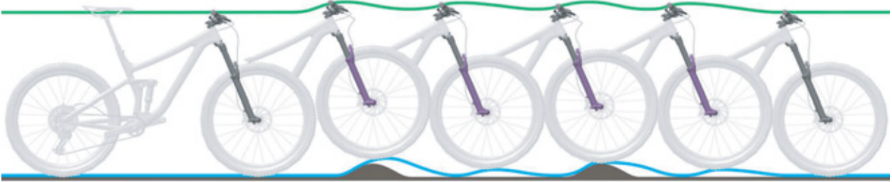
228. ábra: A teleszkópos villa túl gyors kirugózása
