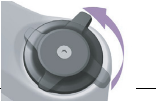
144. ábra: A nyomásfokozat-beállító puhább beállítása
