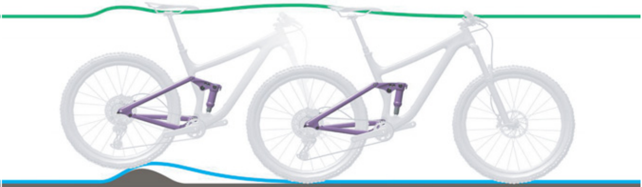
242. ábra: A hátsó lengéscsillapító túl kemény csillapítása egyenetlenségeknél
