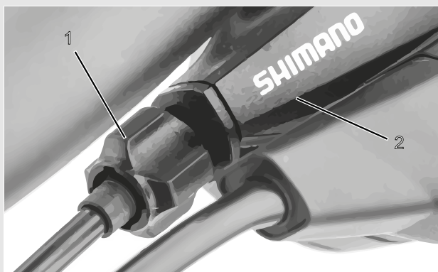
Obr. 84: Seřizovací pouzdro (1) řazení převodů ovládané jedním lankem s řadicí páčkou (2) - příklad
