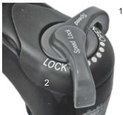
Obr. 78: Nastavovací šroub komprese Suntour s polohami OPEN (1) a LOCK (2)
