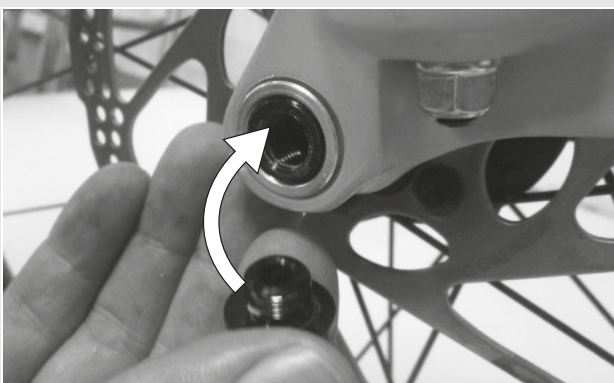
Obr. 26: Zasuňte páku rychloupínáku do osy
