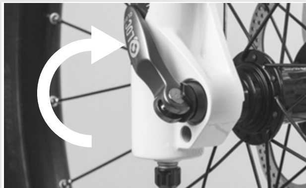
Figura 26: Chiusura del bloccaggio rapido
