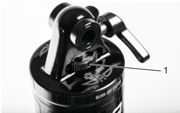
Figura 42: Regolatore del rebound Suntour (1) sull'ammortizzatore del carro posteriore
