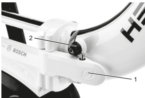
Figura 59: Leva di sicurezza del telaio chiusa (1) e aperta (2)
