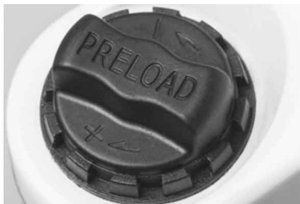
Figura 38: Manopola di regolazione dell'escursione negativa della sospensione sulla corona della forcella ammortizzata
