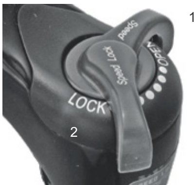
Figura 52: Regolatore dello stadio di pressione Suntour con posizioni OPEN (1) e LOCK (2)
