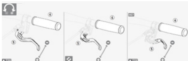
Figura 36: Regolazione dell'ampiezza di presa della leva del freno Magura con freno a disco
