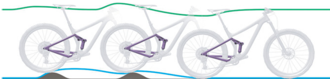
Afbeelding 265: Te langzaam uitveren van de achterbouwdemper
