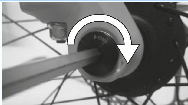
Figura 63: Serraggio del perno nel verso della freccia
