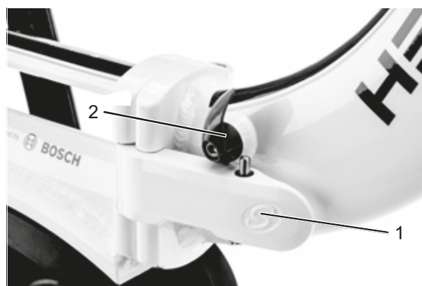
Figura 137: Leva di sicurezza del telaio chiusa (1) e aperta (2)
