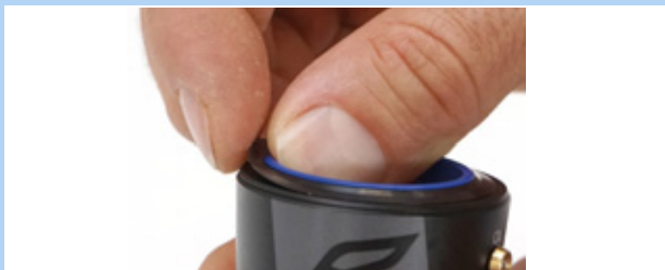
Figura 204: Estrazione dell'anello a labbro di tenuta
