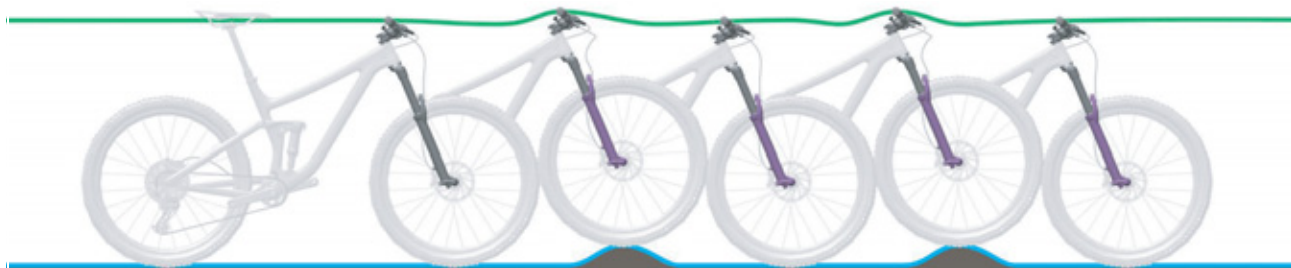
Figura 11: Comportamento di marcia ottimale della forcella
