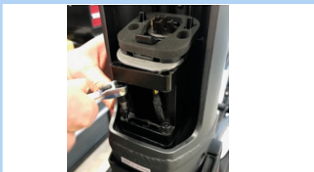
Figura 48: Rimozione delle viti a testa esagonale da 4 mm
