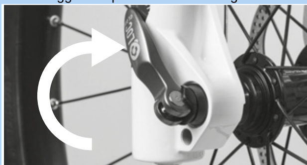
Figura 75: Chiusura del bloccaggio rapido
