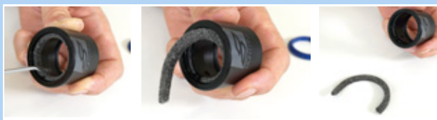
Figura 172: Rimozione dell'anello di feltro
