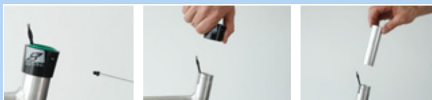
Figura 169: Smontaggio della boccola esterna e del manicotto scorrevole
