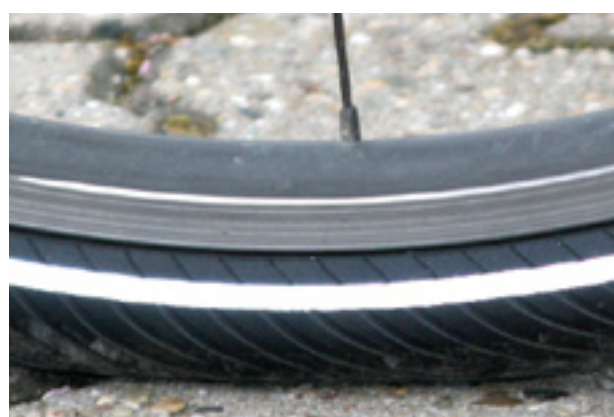
Figura 97: Corretta pressione di gonfiaggio. Lo pneumatico quasi non si deforma sotto il peso corporeo
