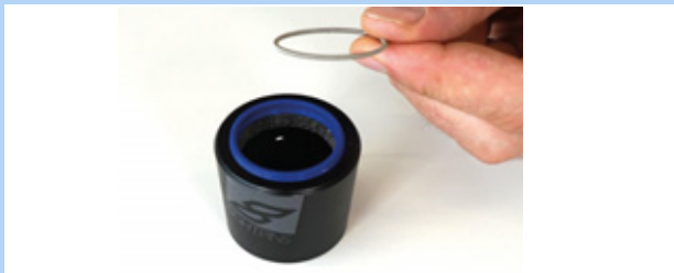
Figura 205: Anello elastico smontato
