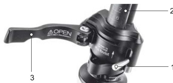
Figura 135: Leva di serraggio (3) del bloccaggio rapido dell'attacco manubrio aperta sull'attacco manubrio (2), versione I, con leva di sicurezza (1) sull'attacco manubrio
