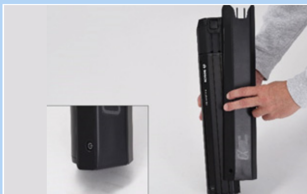
Figura 59: Applicazione della copertura della batteria sulla batteria
