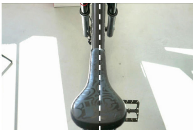
Figura 80: Posizionamento della sella in direzione di marcia
