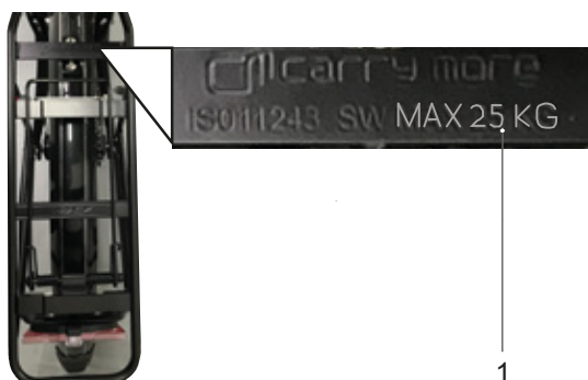
Figura 118: Sul portapacchi è indicata la sua portata massima (1).
