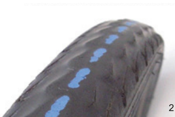
Figura 148: Pneumatico senza profilo ancora utilizzabile (1) e pneumatico con protezione contro le forature in vista (2) che deve essere sostituito
