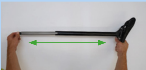
Figura 213: Estrazione completa del tubo del canotto reggisella
