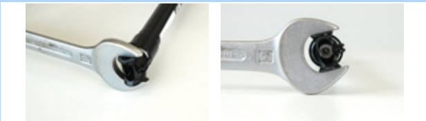
Figura 182: Bloccaggio per impedire la rotazione
