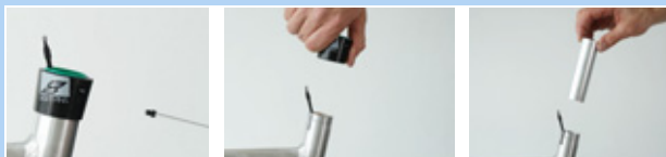
Figura 203: Smontaggio della boccola esterna e del manicotto scorrevole
