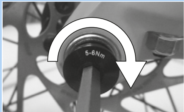
Figura 65: Serraggio della vite di sicurezza
