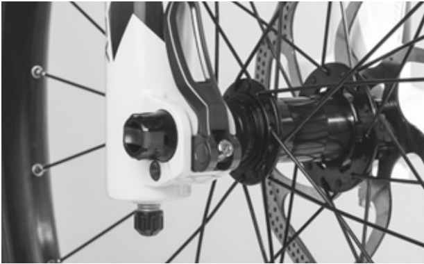
Figura 70: Corretta posizione della leva di serraggio
