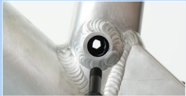
Figura 221: Foro dell'interfaccia Postpin
