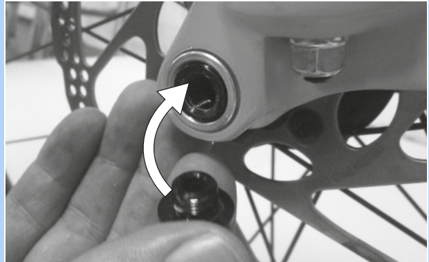
Figura 64: Applicazione della leva del bloccaggio rapido nel perno
