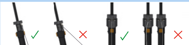
Figura 188: Cavo meccanico corretto ed errato
