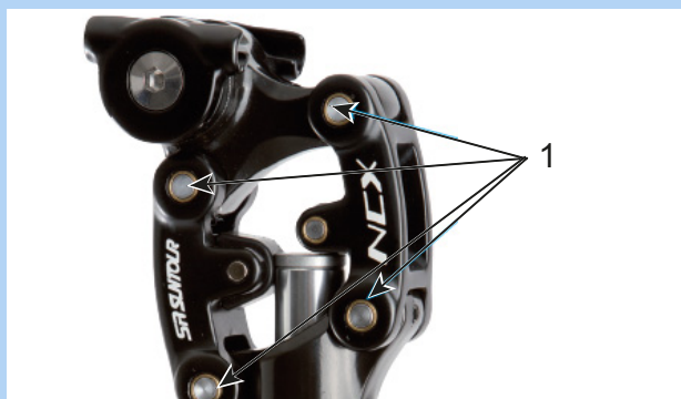
Figura 160: Punti di lubrificazione del cannotto reggisella ammortizzato SR Suntour
