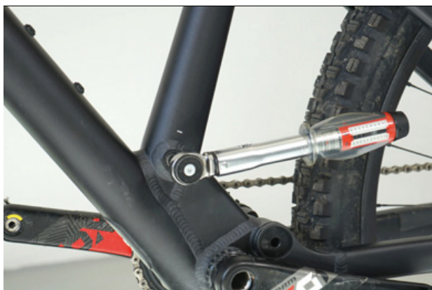
Figura 81: Serraggio dell'asse del canotto reggisella
