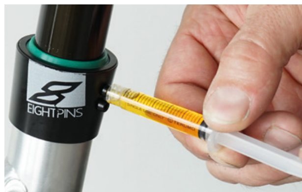
Figura 146: Lubrificazione del tubo del cannotto reggisella
