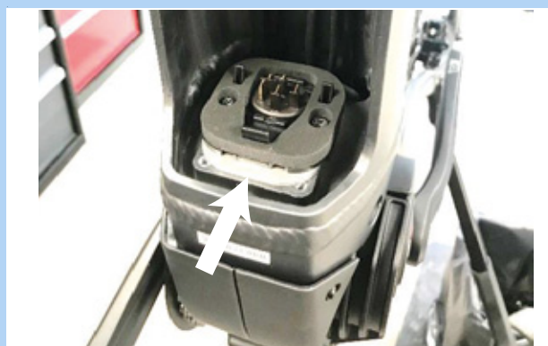
Figura 51: Piastre dell'adattatore incorporate
