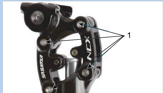
Illustration 187 : Points de lubrification de la tige de selle suspendue SR SUNTOUR
