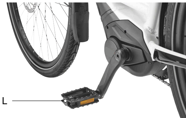
Illustration 85 : Pédale L dans le bras de manivelle gauche
