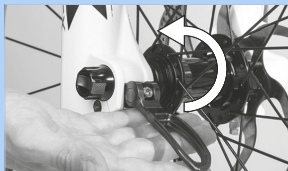
Illustration 75 : Enfoncez le levier d'attache rapide dans le sens de la flèche
