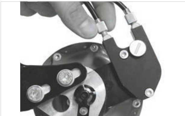
Illustration 182 : Sur les versions de moyeux ROHLOFF avec commande externe du changement de vitesse, le dispositif de réglage de la tension est situé sur le boîtier de câbles qui est placé sur le côté gauche
