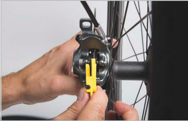
Illustration 156 : Contrôler la plaquette de frein montée à l'aide de la cale de transport
