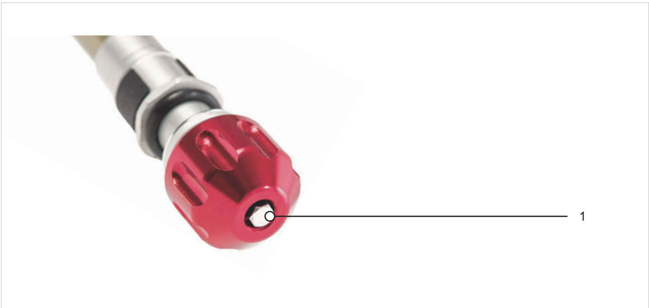
Illustration 190 : Exemple d'un réglage de détente SR SUNTOUR (fourche) (1)
