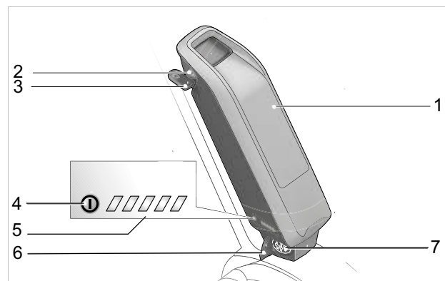
Illustration 46 : Détail d'une batterie sur cadre
