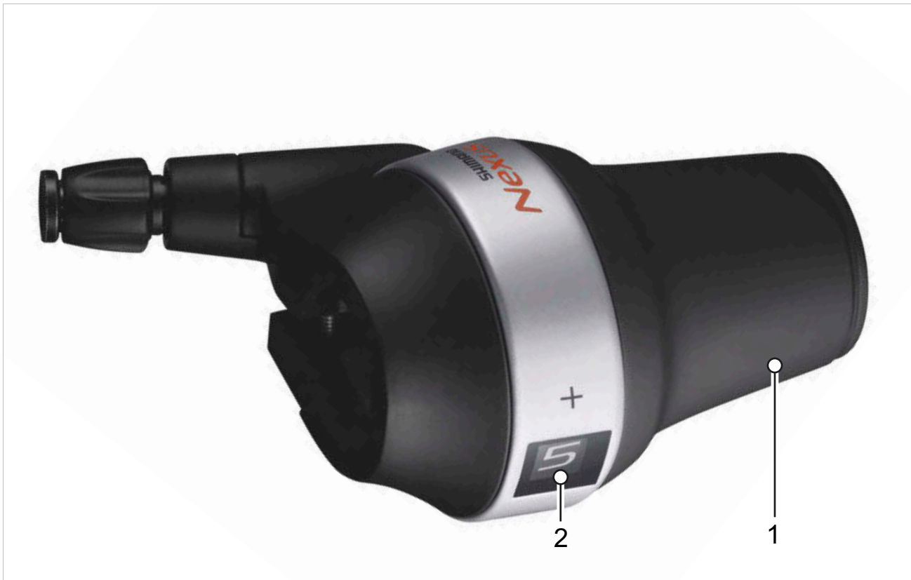
Illustration 61 : Poignée rotative SHIMANO NEXUS SL-C7000-5
