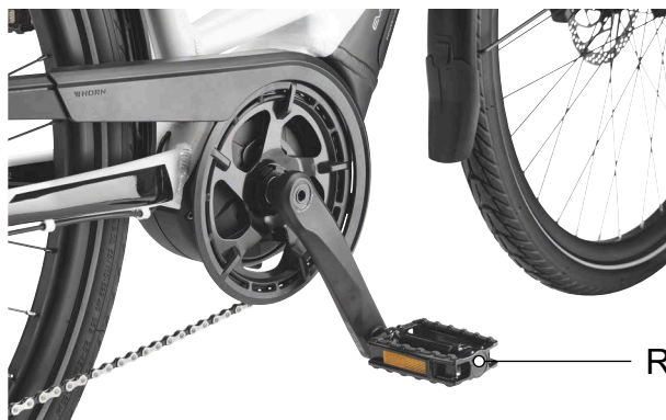
Illustration 86 : Pédale R dans le bras de manivelle droit
