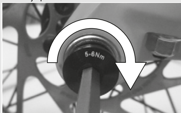
Obr. 29: Utažení pojistného šroubu
