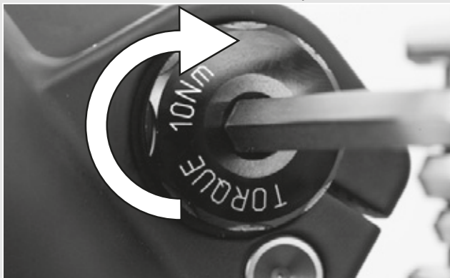
Obr. 30: Utážení zasunuté osy
