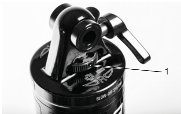
Obr. 60: Nastavovací šroub odskoku Suntour (1) na tlumiči zadního odpružení
