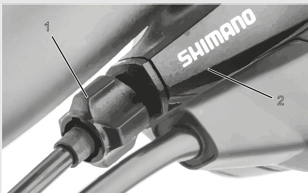
Obr. 85: Seřizovací pouzdro (1) řazení převodů ovládané jedním lankem s řadicí páčkou (2) - příklad
