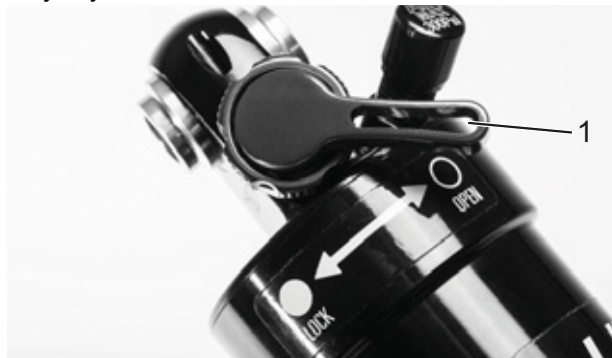
Obr. 76: Nastavovací šroub komprese Suntour otevřený (1)
