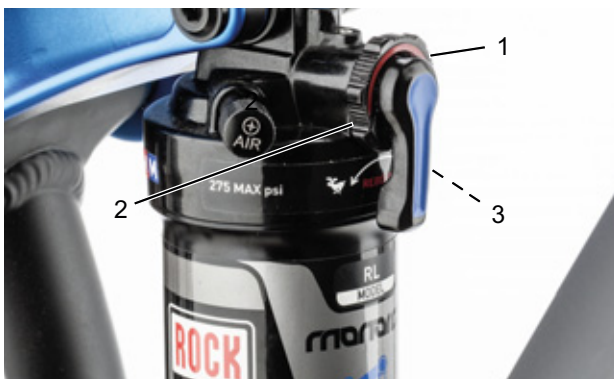
Obr. 78: Nastavení tvrdosti tlumiče odskoku zadního odpružení nastavovacím kolečkem (1)
