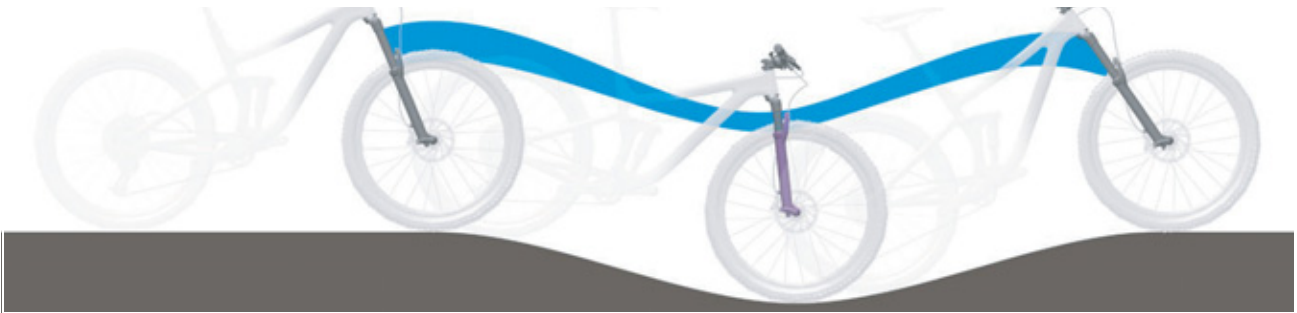
74. ábra: A teleszkópos villa túl puha rugózása hegymenetben
