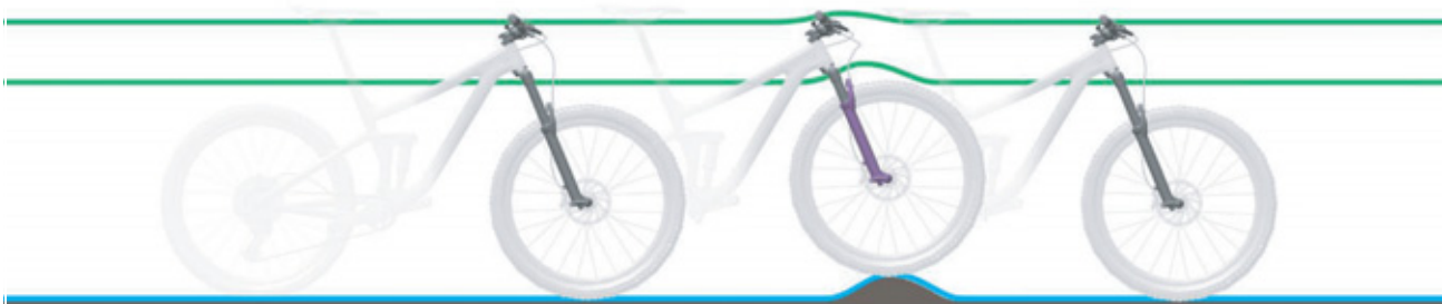
61. ábra: Optimális menetviselkedés egyenetlenségek esetén
