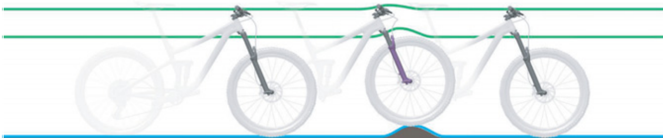
7. ábra: A villa optimális menetviselkedése egyenetlenségek esetén
