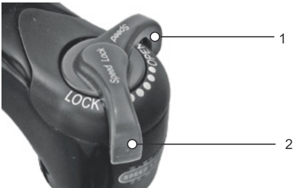
75. ábra: Suntour nyomásfokozat-lengéscsillapító nyitott (1) és zárt (2) helyzetben
