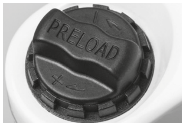
40. ábra: Az SAG (negatív rugóút) beállító kereke a teleszkópos villa koronáján
