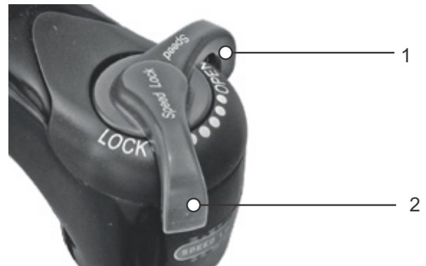
62. ábra: Suntour nyomásfokozat-lengéscsillapító nyitott (1) és zárt (2) helyzetben
