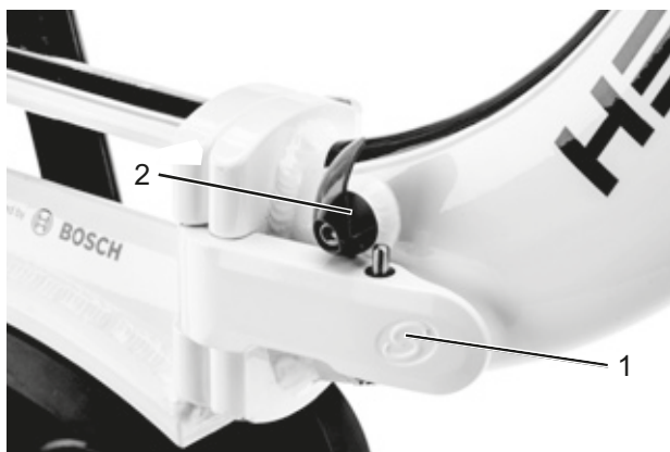
Obr. 59: Zavřená (1) a otevřená (2) pojistná páka rámu
