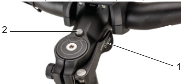
Obr. 58: Představec, provedení II s upínací pákou rychloupínáku představce (1) a odblokovacím knoflíkem (2)
