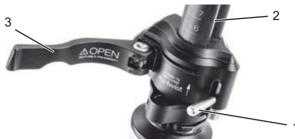
Obr. 57: Otevřená upínací páka rychloupínáku (3) představce (2) v provedení I s pojistnou pákou na představci (1)
