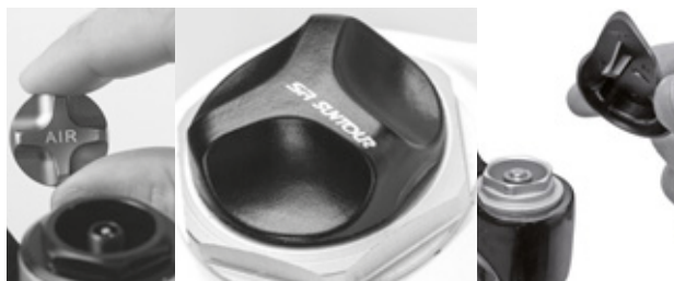
Obr. 39: Sroubovací krytka může mít různé provedení
