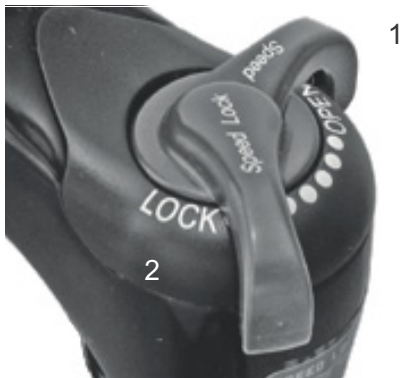
Obr. 52: Nastavovací šroub komprese Suntour s polohami OPEN (1) a LOCK (2)
