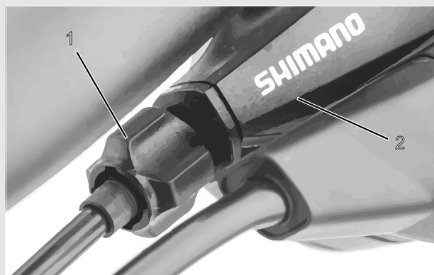
Obr. 66: Seřizovací pouzdro (1) řazení převodů ovládané jedním lankem s řadicí páčkou (2), příklad
