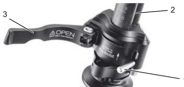
Illustration 41 : Levier de serrage ouvert de l'attache rapide de la potence (3) sur la potence (2), modèle I, avec levier de blocage sur la potence (1)
