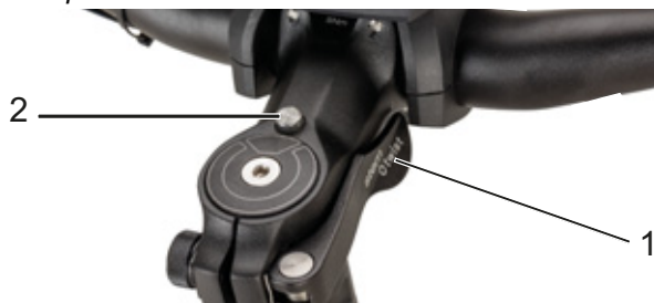
Illustration 42 : Potence, modèle II avec levier de serrage de l'attache rapide de la potence (1) et bouton de déblocage (2)
