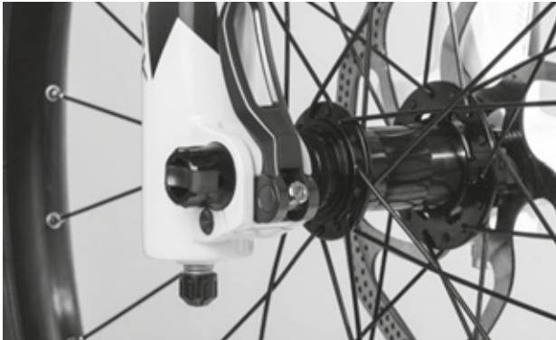
Illustration 48 : Régler la force de serrage de l'attache rapide
