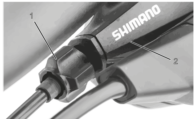
Illustration 50 : Douille de réglage (1) du changement de vitesse à un câble actionné par câble avec boîtier de manette de vitesse (2), exemple
