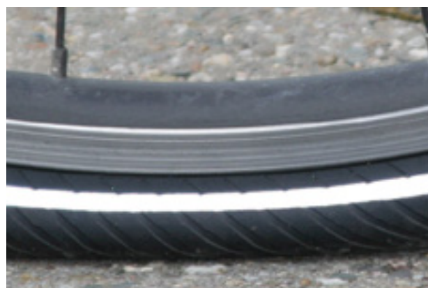
Illustration 108 : Pression largement insuffisante
