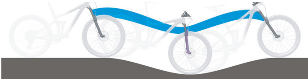
Illustration 6 : Comportement optimal de la fourche en terrain vallonné
