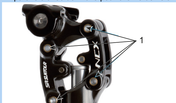
Illustration 168 : Points de lubrification de la tige de selle suspendue SR Suntour
