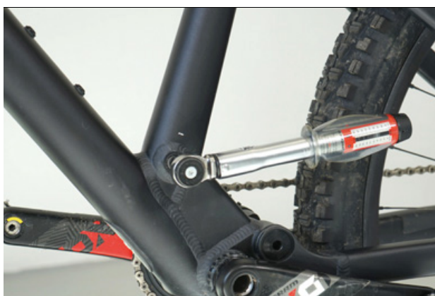
Illustration 85 : Serrer l'axe de la tige de selle
