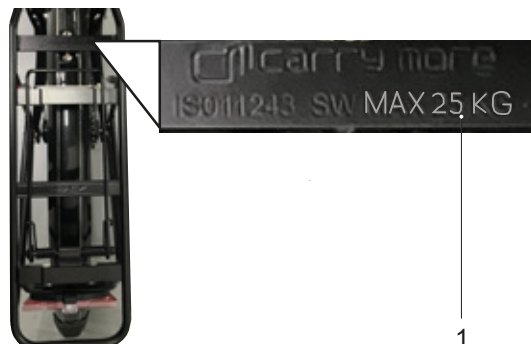
Illustration 127 : La capacité de charge maximale (1) est indiquée sur le porte-bagages.
