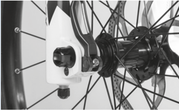
Illustration 166 : Régler la force de serrage de l'attache rapide
