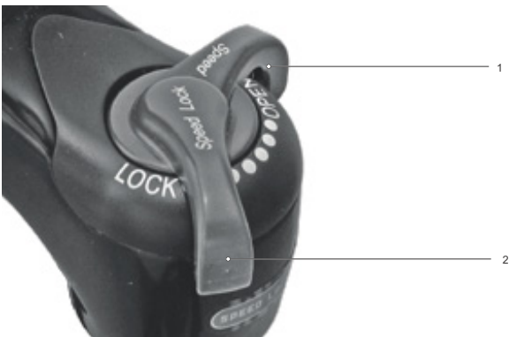
Illustration 236 : Régler le dispositif de réglage de la compression sur un niveau plus dur
