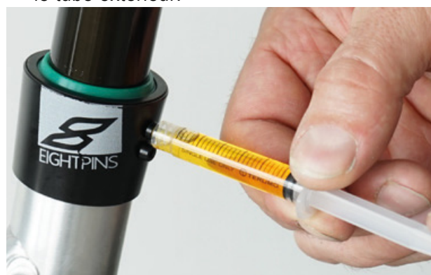
Illustration 154 : Lubrifier un tube de tige de selle
