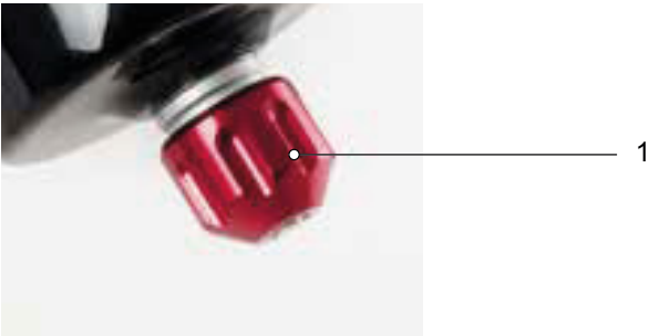
Illustration 232 : Vis de détente Suntour (1)
