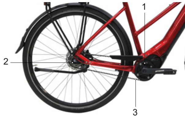
Illustration 27 : Schéma de l'entraînement à courroie
