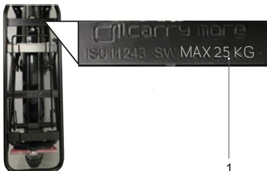
Illustration 141 : La capacité de charge maximale (1) est indiquée sur le porte-bagages.
