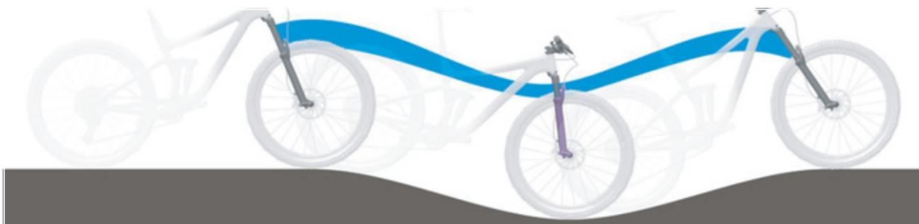
Illustration 219 : Suspension trop souple de la fourche suspendue dans les côtes
