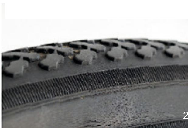
Illustration 166 : Exemples de fissures de fatigue (1) et de fissures d'âge (2)
