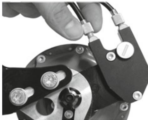
Illustration 192 : Sur les versions de moyeux ROHLOFF avec commande externe du changement de vitesse, le dispositif de réglage de la tension est situé sur le boîtier de câbles qui est placé sur le côté gauche.
