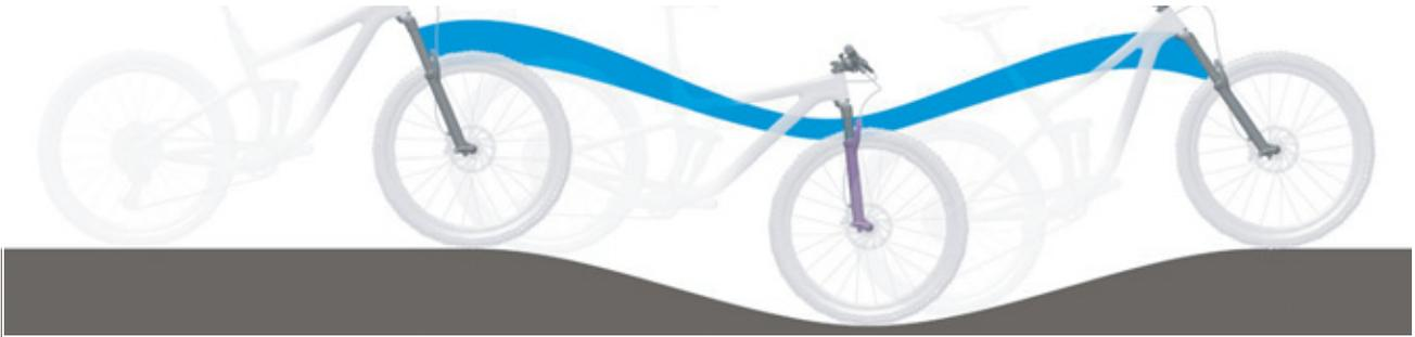
Illustration 203 : Suspension trop souple de la fourche suspendue dans les côtes
