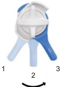
Illustration 126 : Réglage du levier à 3 positions : fermé (1), moyen (2) et ouvert (3)
