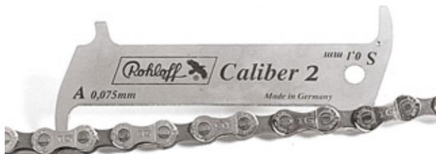
Illustration 172 : Exemple d'un gabarit de mesure ROHLOFF
