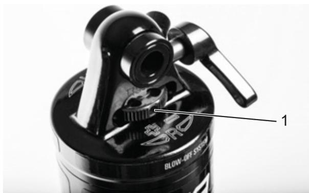
Illustration 226 : Molette de réglage de la détente SR SUNTOUR (1) sur l'amortisseur arrière
