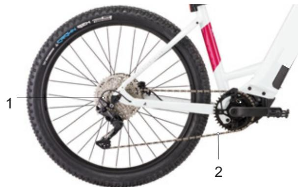
Illustration 31 : Schéma de l'entraînement à chaîne avec dérailleur
