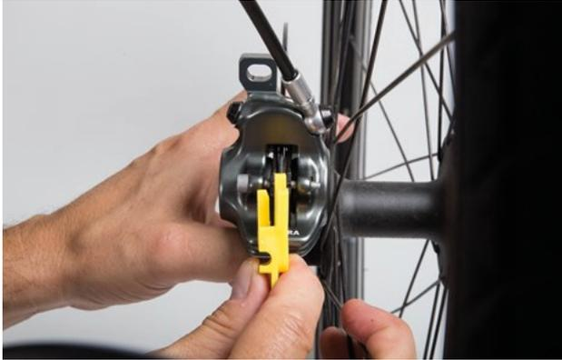
Illustration 167 : Contrôler la plaquette de frein montée à l'aide de la cale de transport
