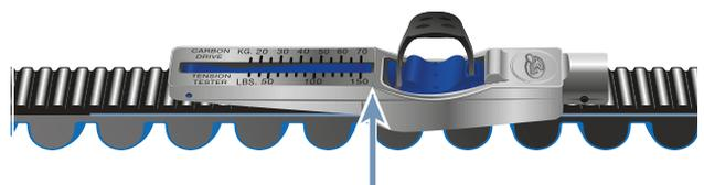
**Illustration 183 : Gabarit de contrôle sur la courroie**
