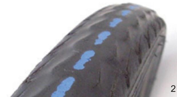
Illustration 155 : Pneu sans profil pouvant être changé (1) et pneu avec protection anti-crevaison visible (2) devant être changé
