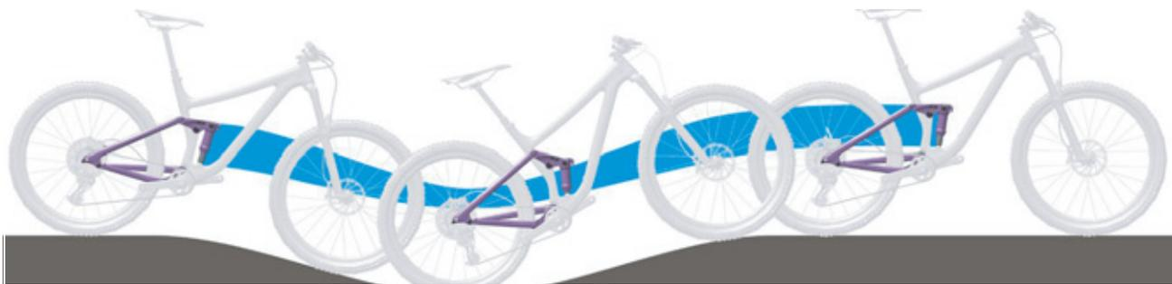
Illustration 229 : Suspension trop souple de l'amortisseur arrière dans les côtes
