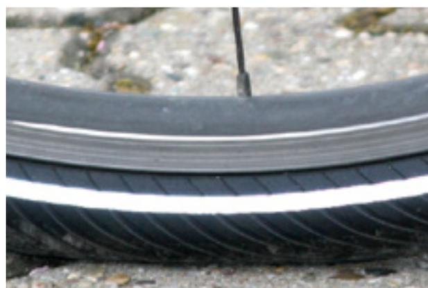
**Illustration 112 : Pression correcte. Le pneu se déforme à peine sous le poids du corps.**
