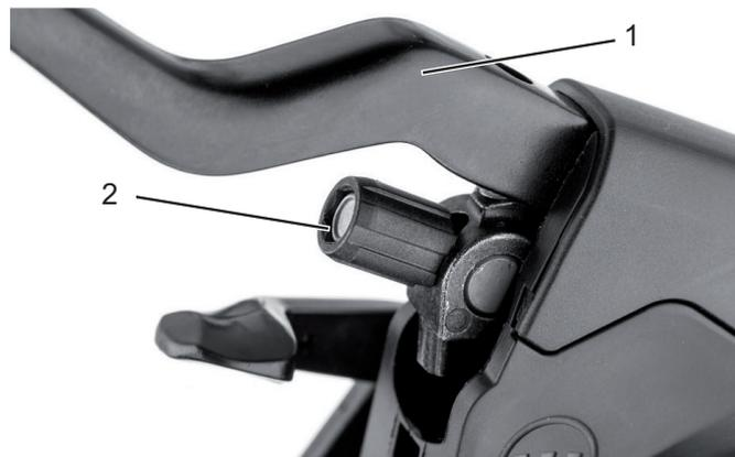
**Abbildung 79:** Bremshebel (1) der hydraulisch betätigten Felgenbremse mit Einstellschraube (2)
