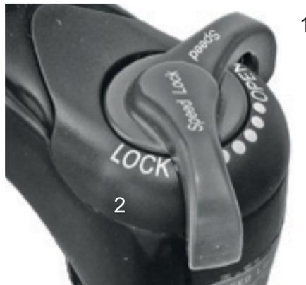
Abbildung 50: Suntour-Druckstufeneinsteller mit den Positionen OPEN (1) und LOCK (2)
