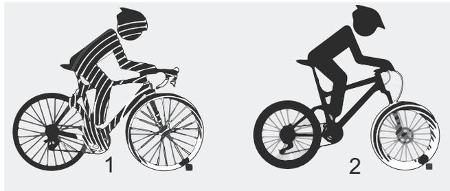
**Abbildung 4:** Fahrrad ohne Federung (1) und mit Federung (2) beim Fahren über ein Hindernis
