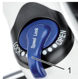
► Per bloccare la *sospensione della ruota anteriore*, spingere la *leva di bloccaggio* in posizione LOCK.
