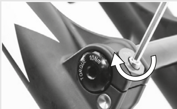
Rysunek 31: Sposób dokręcania osi
