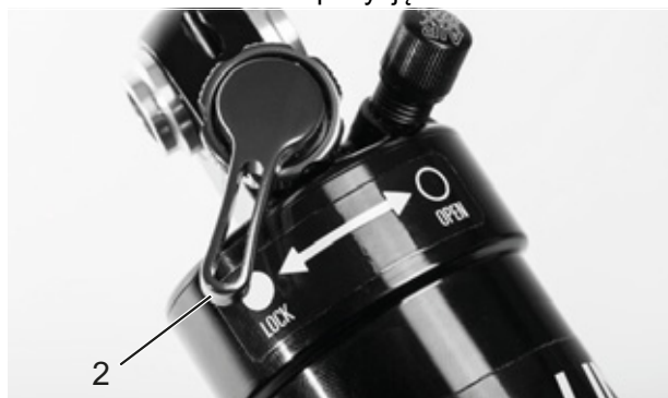
Rysunek 77: Nastawnik dobicia Suntour w pozycji zamkniętej (2)
