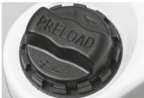
Rysunek 56: Pokrętko regulacyjne ujemnego skoku sprężyny, usytuowane na koronie widelca amortyzowanego
