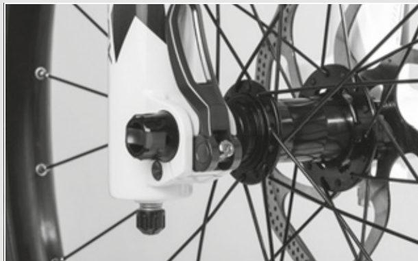
Rysunek 36: Optymalne położenie dźwigni mocującej
