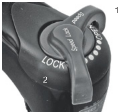
Rysunek 75: Nastawnik dobicia Suntour z pozycjami OPEN (1) i LOCK (2)
