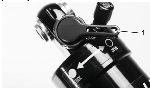
Rysunek 76: Nastawnik dobicia Suntour w pozycji otwartej (1)
