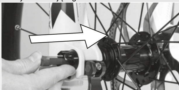
Rysunek 34: Sposób wsuwania dźwigni zacisku szybko mocującego w oś
