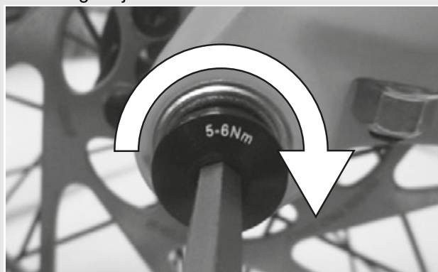
Rysunek 29: Sposób dokręcania śruby zabezpieczającej
