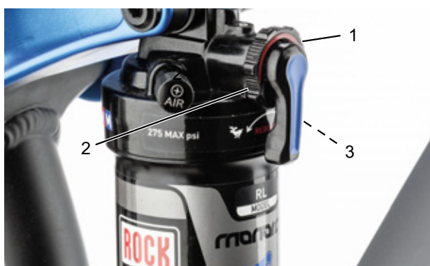
Rysunek 78: Ustawianie twardości tłumika odbicia za pomocą pokrętła regulacyjnego (1)
