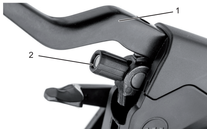
Afbeelding 73: Remhendel (1) van de hydraulisch bediende velgrem met afstelschroef (2)
