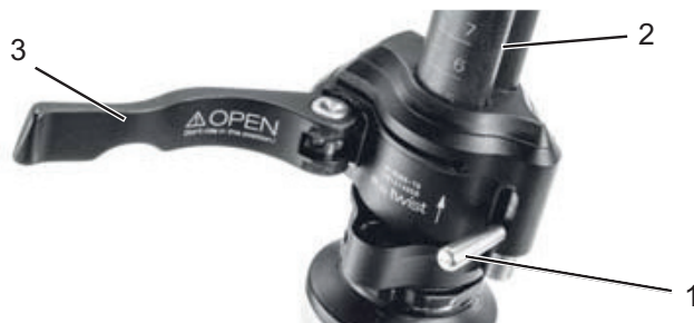
Afbeelding 58: Geopende spanhendel van de snelspanner (3) op de voorbouw (2), uitvoering I, met vergrendelhendel (1) op de voorbouw
