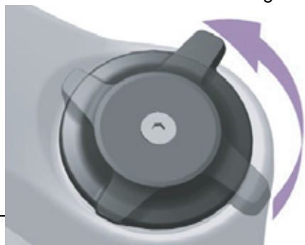
Afbeelding 144: Drukdemperafsteller zachter afstellen
