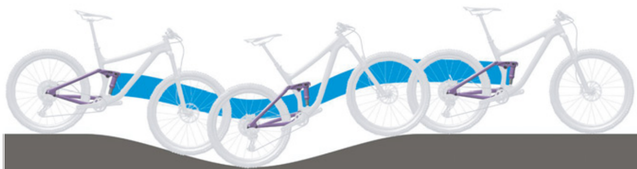
Afbeelding 17: Optimaal rijgedrag van de achterbouwdemper in heuvelachtig terrein
