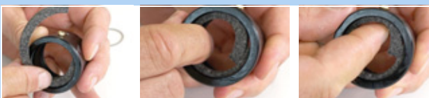
Afbeelding 214: Vilten ring inleggen
