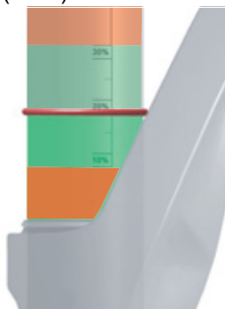
Afbeelding 102: Voorgeschreven sagbereik (groen) en verboden sagbereik (rood)
