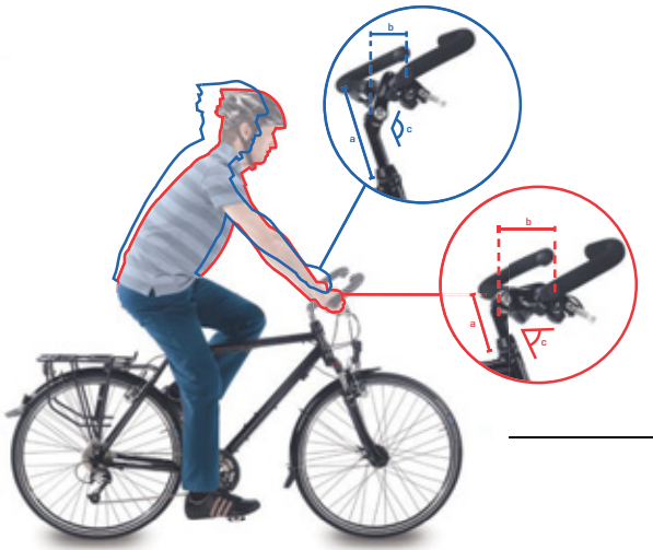
Afbeelding 77: Stadsfiets- (blauw) en toerfietsstand (rood) door verandering van de hoek
