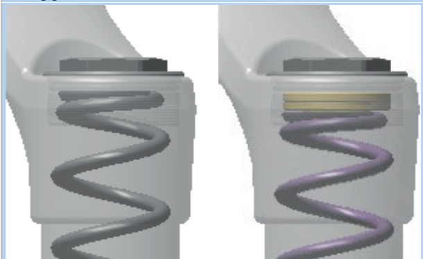
Afbeelding 89: Voorspanningsafstelling in- en uitdraaien
