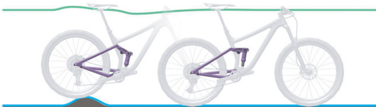
Afbeelding 109: Optimaal rijgedrag van de achterbouwdemper bij oneffenheden
