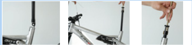
Afbeelding 194: Ventieldop van de patroon aanbrengen
