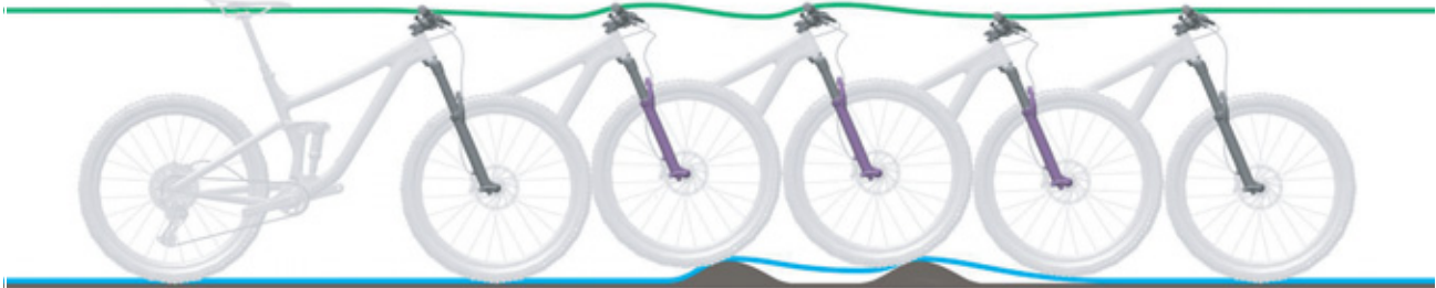
Afbeelding 230: Te langzaam uitveren van de verende voorvork
