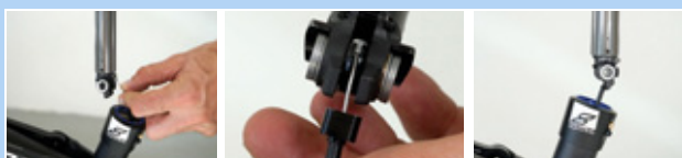
Afbeelding 224: Zadelpen ophangen en inschuiven
