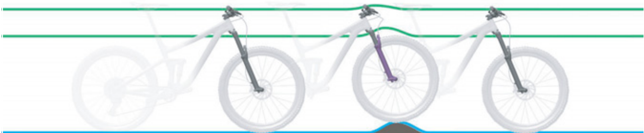
Afbeelding 11: Optimaal rijgedrag van de vork bij oneffenheden
