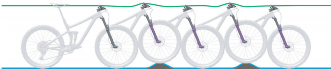
Afbeelding 105: Optimaal rijgedrag van de vork
