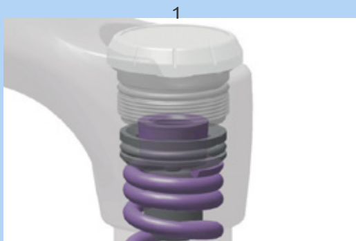
Afbeelding 97: Voorspanningsafstelring in- en uitdraaien
