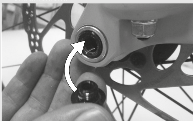
Illustration 30 : Enfoncer le levier d'attache rapide dans l'axe
