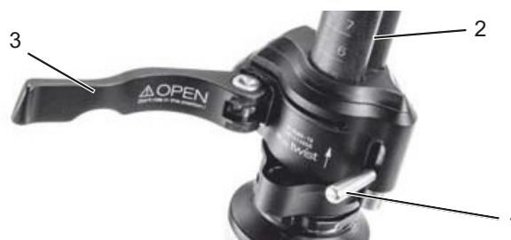
Illustration 71 : Levier de serrage ouvert de l'attache rapide de la potence (3) sur la potence (2), modèle I, avec levier de blocage sur la potence (1)
