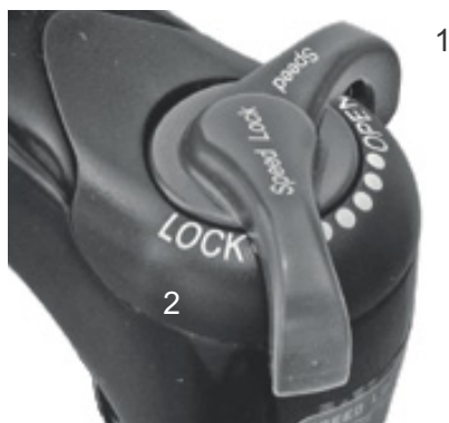
Illustration 87 : Dispositif de réglage de la compression Suntour avec les positions OPEN (1) et LOCK (2)
