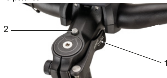
Illustration 72 : Potence, modèle II avec levier de serrage de l'attache rapide de la potence (1) et bouton de déblocage (2)
