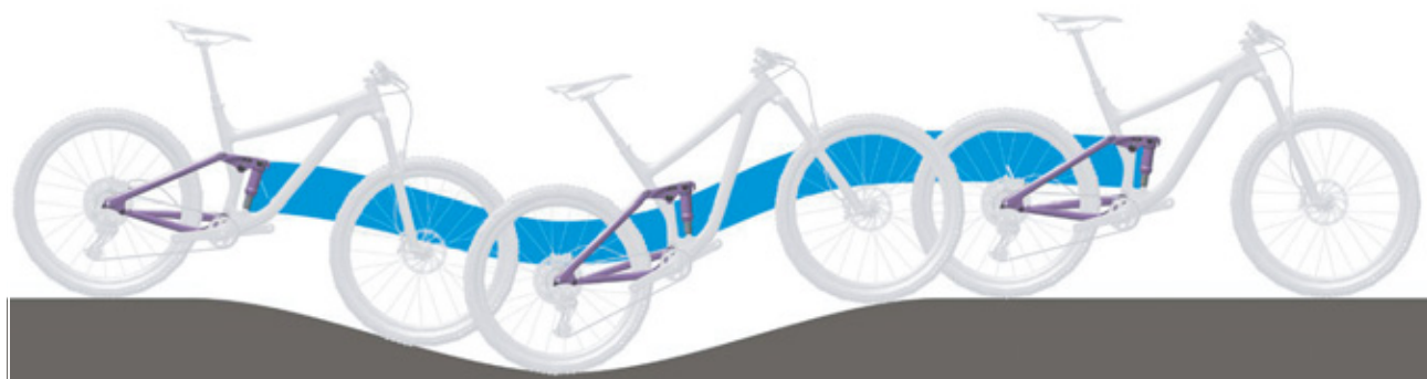
Illustration 20 : Comportement optimal de l'amortisseur arrière en terrain vallonné
