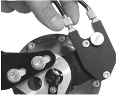
Illustration 159 : Sur les versions de moyeux ROHLOFF avec commande externe du changement de vitesse, le dispositif de réglage de la tension est situé sur le boîtier de câbles qui est placé sur le côté gauche.
