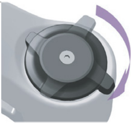
Illustration 233 : Régler le dispositif de réglage de la compression sur un niveau plus dur
