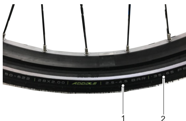
Illustration 152 : Pression des pneus en bar (1) et psi (2)
