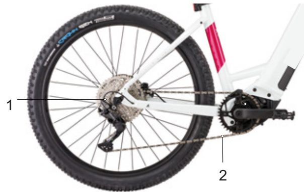
Illustration 33 : Schéma de l'entraînement à chaîne avec dérailleur
