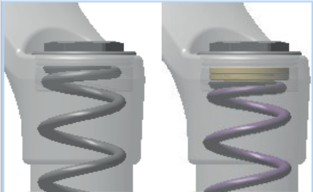
Illustration 89 : Serrer et desserrer l'anneau de réglage de la prétension
