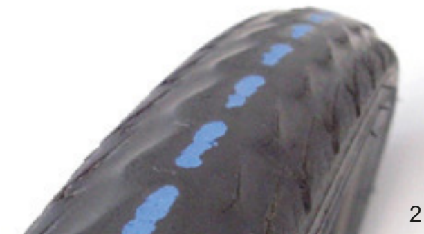
Illustration 153 : Pneu sans profil pouvant encore être utilisé (1) et pneu avec bande de protection visible (2) devant être changé
