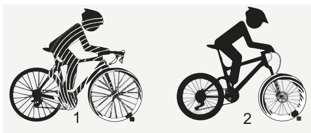
Illustration 7 : sans suspension (1) et avec suspension (2)
