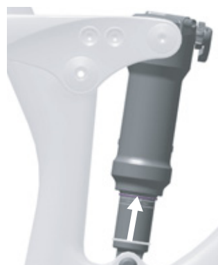
Illustration 104 : Déplacer le joint torique sur l'amortisseur arrière
