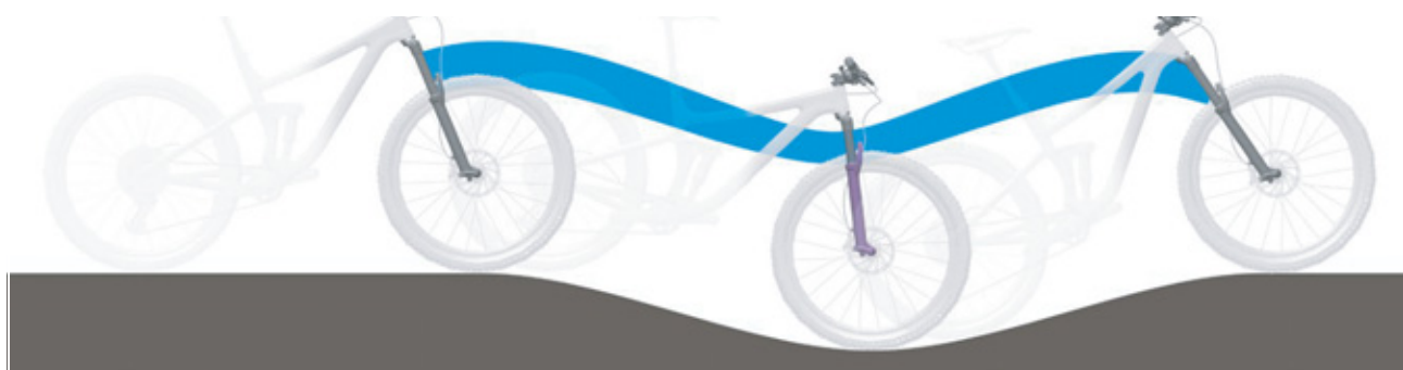
Illustration 10 : Comportement optimal de la fourche en terrain vallonné
