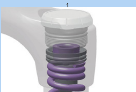
Illustration 97 : Serrer et desserrer l'anneau de réglage de la prétension
