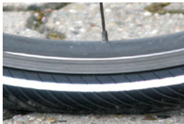
Illustration 79 : Pression correcte. Le pneu se déforme à peine sous le poids du corps
