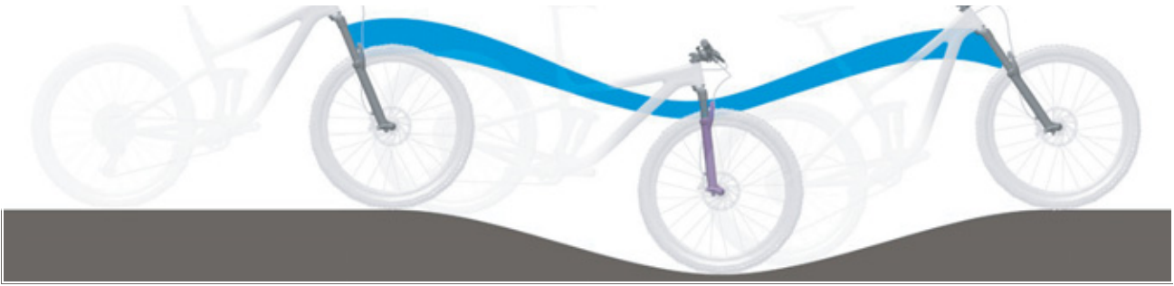
Illustration 232 : Suspension trop souple de la fourche suspendue dans les côtes
