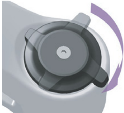
Illustration 143 : Régler le dispositif de réglage de la compression sur un niveau plus dur
