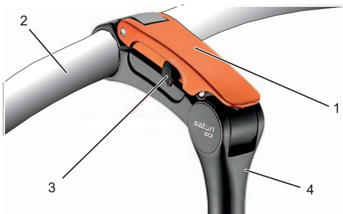
**Figura 5:** Vista detallada de potencia, ejemplo de potencia ajustable sin herramientas
