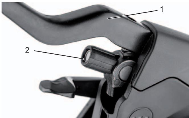
**Figura 28:** Palanca de freno (1) del freno de llanta hidráulico con tornillo de ajuste (2)
