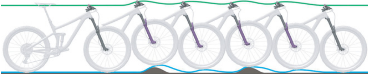
Afbeelding 70: Te snel uitveren van de verende voorvork
