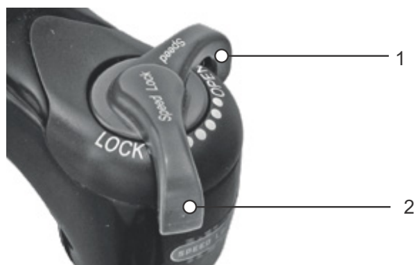
Afbeelding 62: Suntour drukdemper in open (1) en gesloten (2) stand
