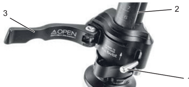
Figur 23: Åbnet greb på hurtigbespændingen (3) på frempinden (2), udførelse I, med låsegreb på frempinden (1)
