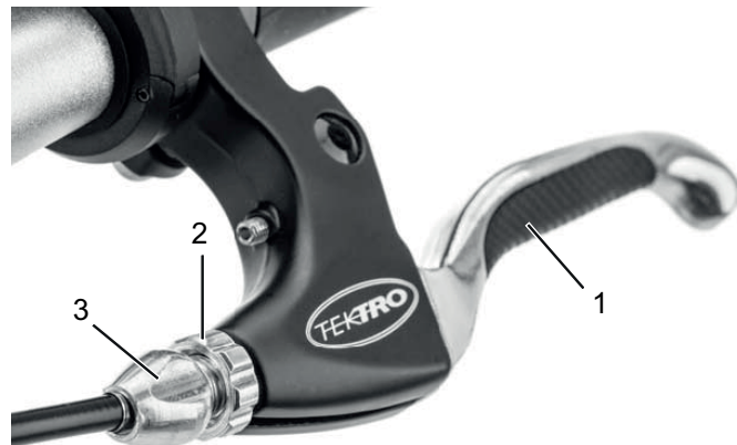
Figur 36: Bremsehåndtag (1), kontramøtrik (2) og indstillingsskrue (3) på den kabelstyrede fælgbremse
