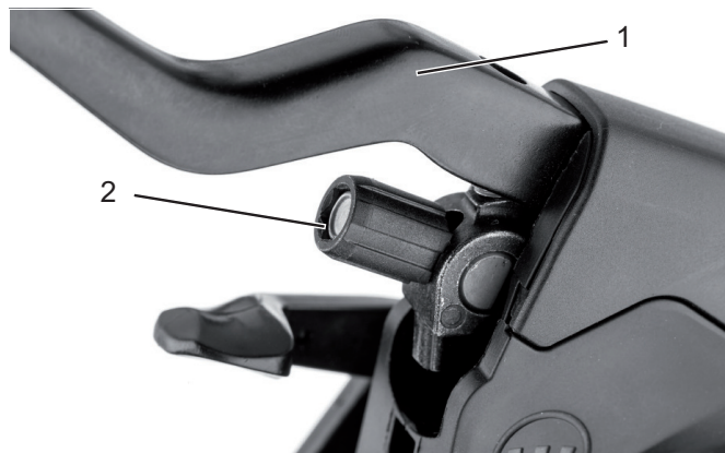
Figur 35: Bremsehåndtag (1) på den hydraulisk aktiverede fælgbremse med indstillingsskrue (2)
