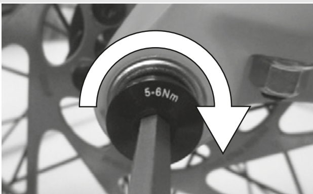
Figura 28: Serraggio della vite di sicurezza
