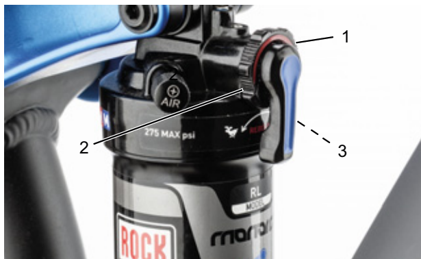
Figura 83: Regolazione della rigidità dell'ammortizzatore a stadi di trazione con la manopola di regolazione (1) dell'ammortizzatore del carro posteriore
