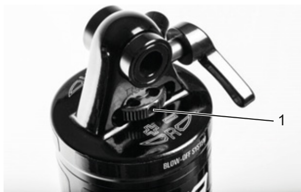
Figura 60: Regolatore del rebound Suntour (1) sull'ammortizzatore del carro posteriore
