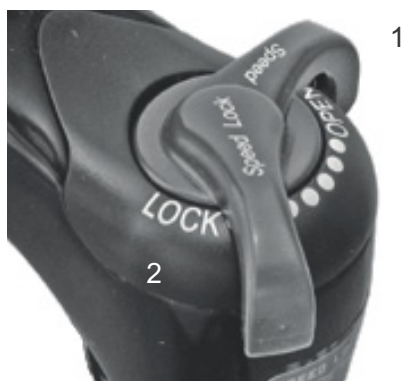
Figura 80: Regolatore della compressione Suntour con posizioni OPEN (1) e LOCK (2)
