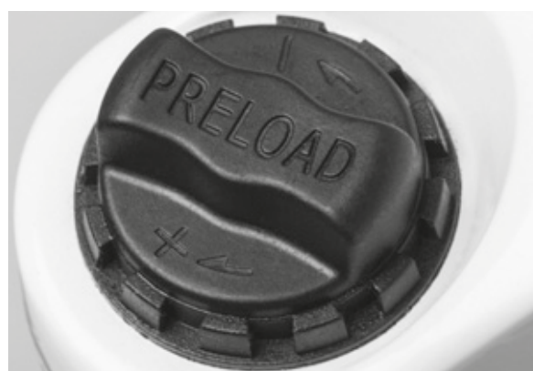
Figura 57: Manopola di regolazione dell'escursione negativa della sospensione sulla corona della forcella ammortizzata
