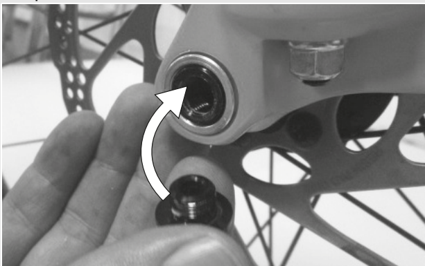
Figura 27: Applicazione della leva del bloccaggio rapido nel perno
