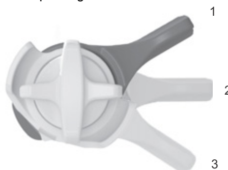
Figura 78: Regolatore della compressione FOX sull'ammortizzatore del carro posteriore con le posizioni APERTO (1), MEDIO (2) e RIGIDO (3)
