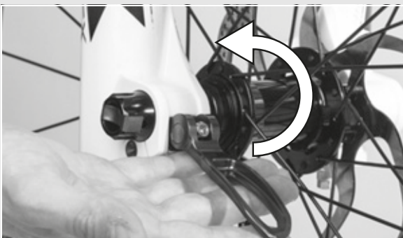
Figura 34: Bloccaggio della leva
