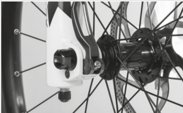
Figura 35: Corretta posizione della leva di serraggio
