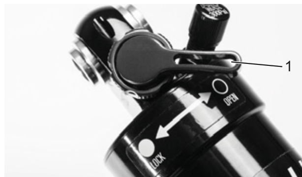
Figura 81: Regolatore della compressione Suntour aperto (1)
