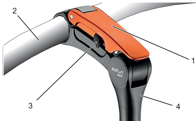
Abbildung 5: Detailansicht Vorbau, Beispiel werkzeuglos einstellbarer Vorbau
