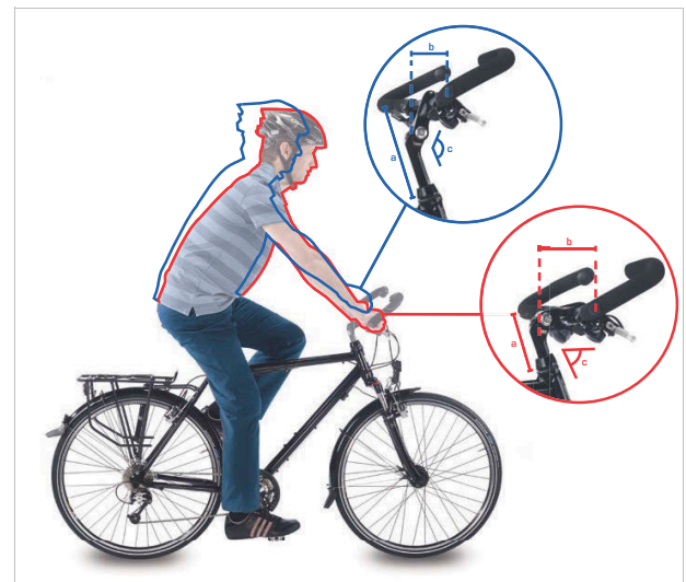
97. ábra: Városi kerékpár (kék) és túrakerékpár (piros) a szög változtatásával
