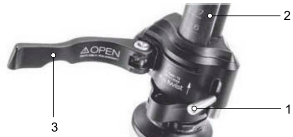
138. ábra: A kormányszár-gyorszár (3) nyitott gyorskioldója a kormányszáron (2), I kivitel, a kormányszáron (1) lévő rögzítőkarral
