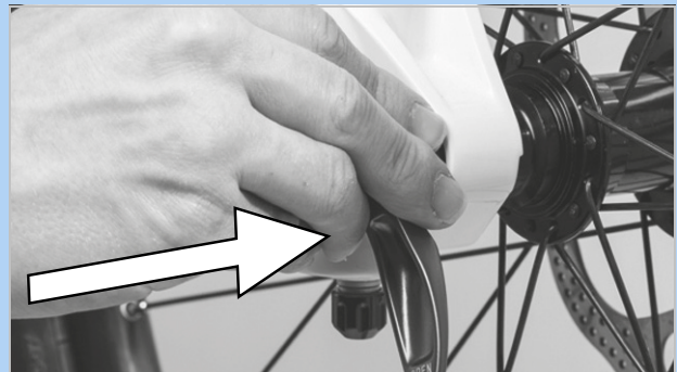
68. ábra: A gyorsár betolása nyilirányban
