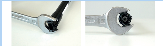
Abbildung 155: Gegen Verdrehen sichern
