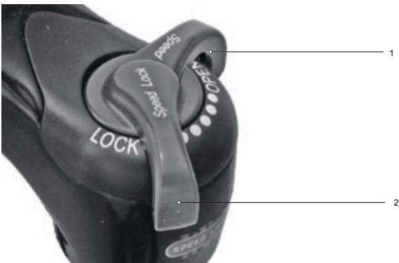
Abbildung 201: Druckstufeneinsteller härter einstellen
