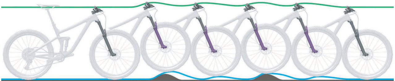
Abbildung 196: Zu schnelles Ausfedern der Federgabel
