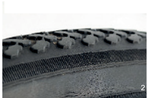
Abbildung 123: Beispiele für Ermüdungsrisse (1) und Alterungsrisse (2)
