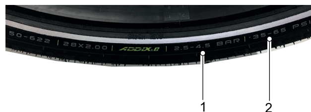
Abbildung 121: Fülldruck in bar (1) und psi (2)
