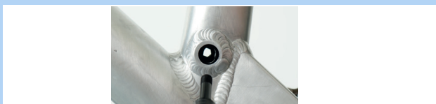
Abbildung 163: Kartusche Ventildeckel befestigen
