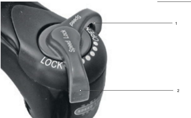
Abbildung 203: Druckstufeneinsteller weicher einstellen
