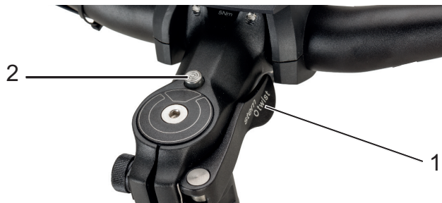
Figur 45: Frempind, udførelse II med greb på frempindens hurtigbespænding (1) og frigørelsesknap (2)
