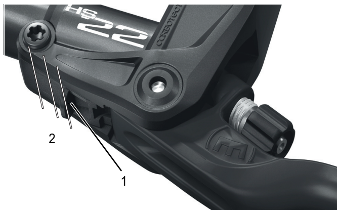
Figur 32: Bremsehåndtag med skyder (1) og dets tre positioner (2)
