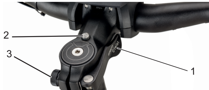
Figur 24: Frempind, udførelse II med greb (1), frigørelsesknop (2) og fingermøtrik (3)
