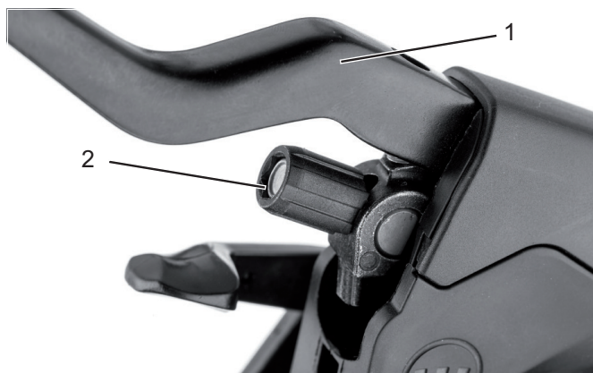
Figur 65: Bremsehåndtag (1) på den hydraulisk aktiverede fælgbremse med indstillingsskrue (2)
