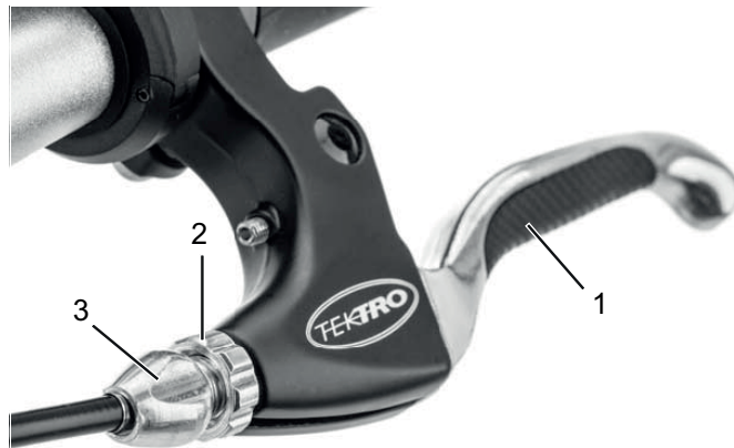
Figur 66: Bremsehåndtag (1), kontramøtrik (2) og indstillingsskrue (3) på den kabelstyrede fælgbremse
