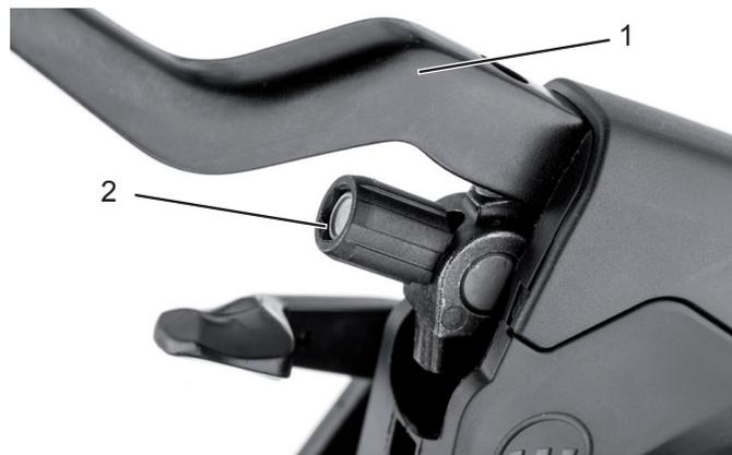
Figura 65: Palanca de freno (1) del freno de llanta hidráulico con tornillo de ajuste (2)
