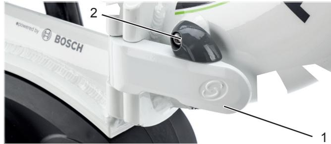
**Figura 47:** Cuadro, con palanca tensora del cuadro cerrada (1) y palanca de seguridad del cuadro cerrada (2)
