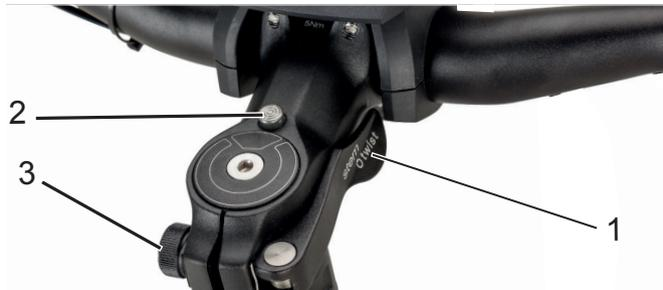
**Figura 24:** Potencia, versión II con palanca tensora (1), botón de desbloqueo (2) y tuerca moleteada (3)
