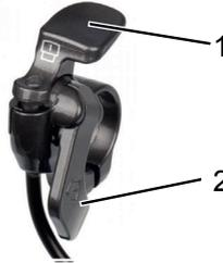
► Para desbloquear la *suspensión de la rueda delantera* debe presionarse la palanca de desbloqueo lateral.
