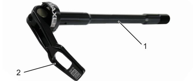
Figura 56: Cierre rápido de la rueda, versión V, con eje (1) y palanca tensora (2)
