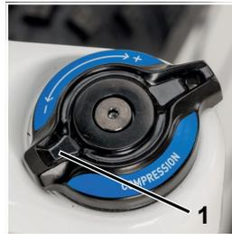
► Para bloquear la suspensión, girar la palanca de bloqueo en dirección +.
