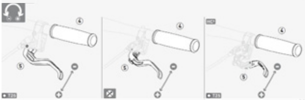
Rysunek 36: Ustawianie odchylenia manetki dźwigni hamulca tarczowego Magura
