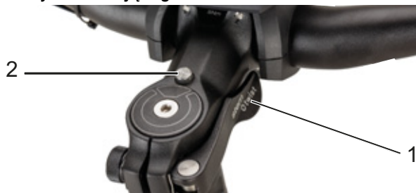
Rysunek 58: Mostek, wersja II z dźwignią mocującą zacisku szybkoemocującego (1) mostka i przyciskiem odblokowującym (2)
