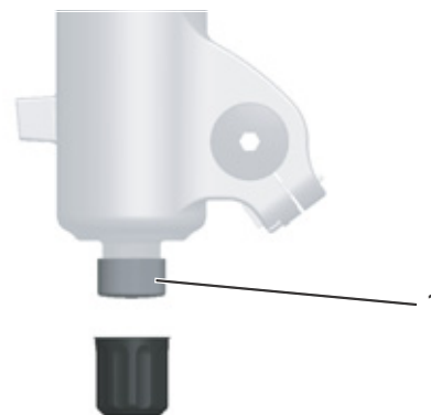
Rysunek 41: Nastawnik odbicia FOX (1) na zabezpieczeniu widelca przed wypadnięciem
