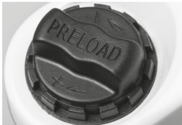
Rysunek 38: Pokrętko regulacyjne ujemnego skoku sprężyny, usytuowane na koronie widelca amortyzowanego
