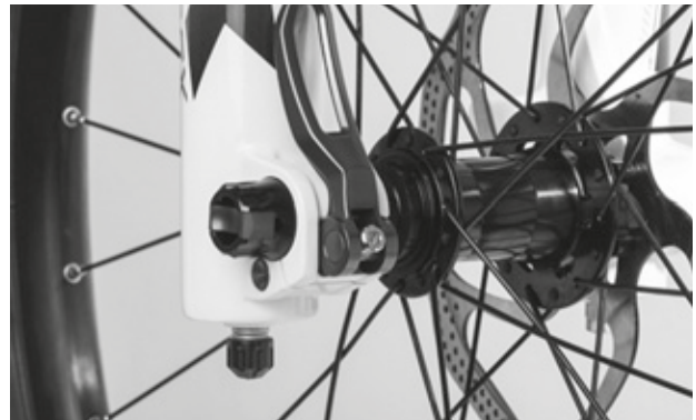
Figur 48: Indstilling af hurtigbespændingens spændekraft
