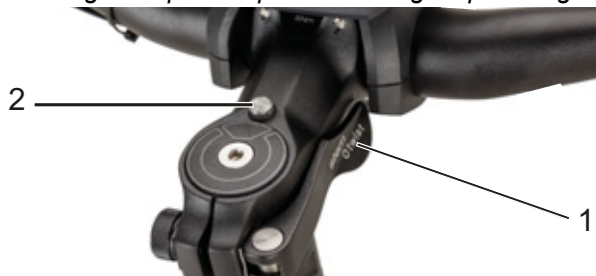
Figur 42: Frempind, udførelse II med greb på frempindens hurtigbespænding (1) og frigørelsesknop (2)
