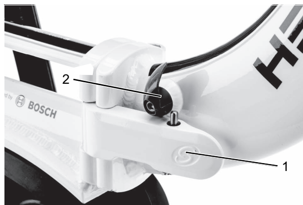
Abbildung 158: Geschlossener (1) und geöffneter (2) Rahmen-Sicherungshebel
