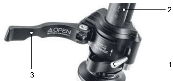
Abbildung 156: Geöffneter Spannhebel des Vorbau-Schnellspanners (3) am Vorbau (2), Ausführung I, mit Sicherungshebel am Vorbau (1)
