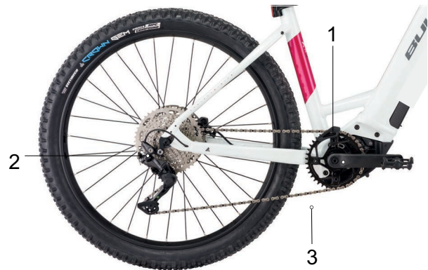
Abbildung 29: Schema Kettenantrieb mit Kettenschaltung
