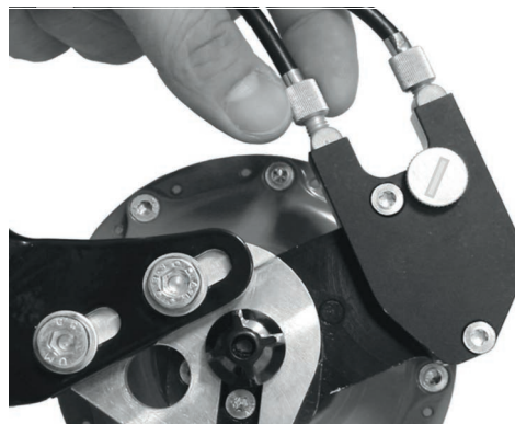
Abbildung 175: ROHLOFF-Naben Versionen mit externer Schaltansteuerung haben die Zugeinsteller an der Seilbox, die sich auf der linken Seite befindet
