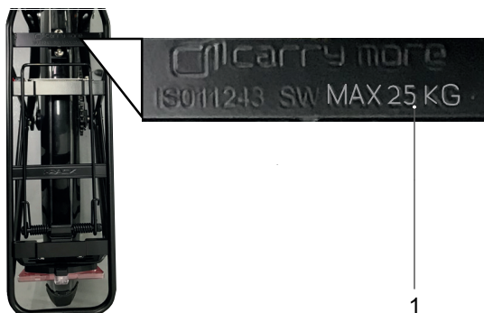
Abbildung 136: Auf dem Gepäckträger ist seine maximale Tragfähigkeit (1) ausgewiesen.
