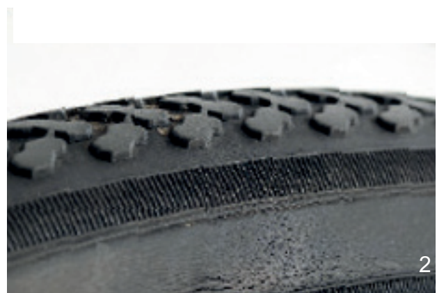
Abbildung 170: Beispiele für Ermüdungsrisse (1) und Alterungsrisse (2)
