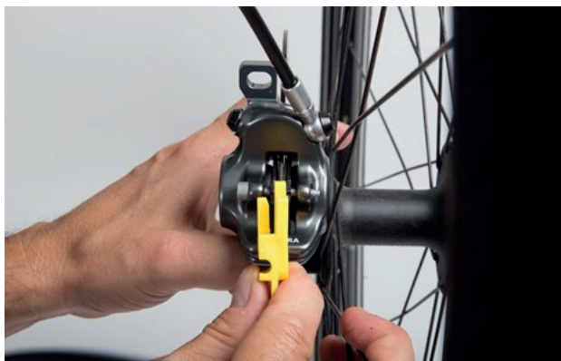
Abbildung 171: Bremsbelag im eingebauten Zustand mithilfe der Transportsicherung prüfen
