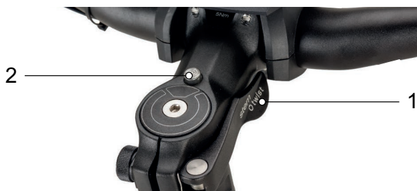
Abbildung 157: Vorbau, Ausführung II mit Spannhebel des Vorbau-Schnellspanners (1) und Entsperrknopf (2)
