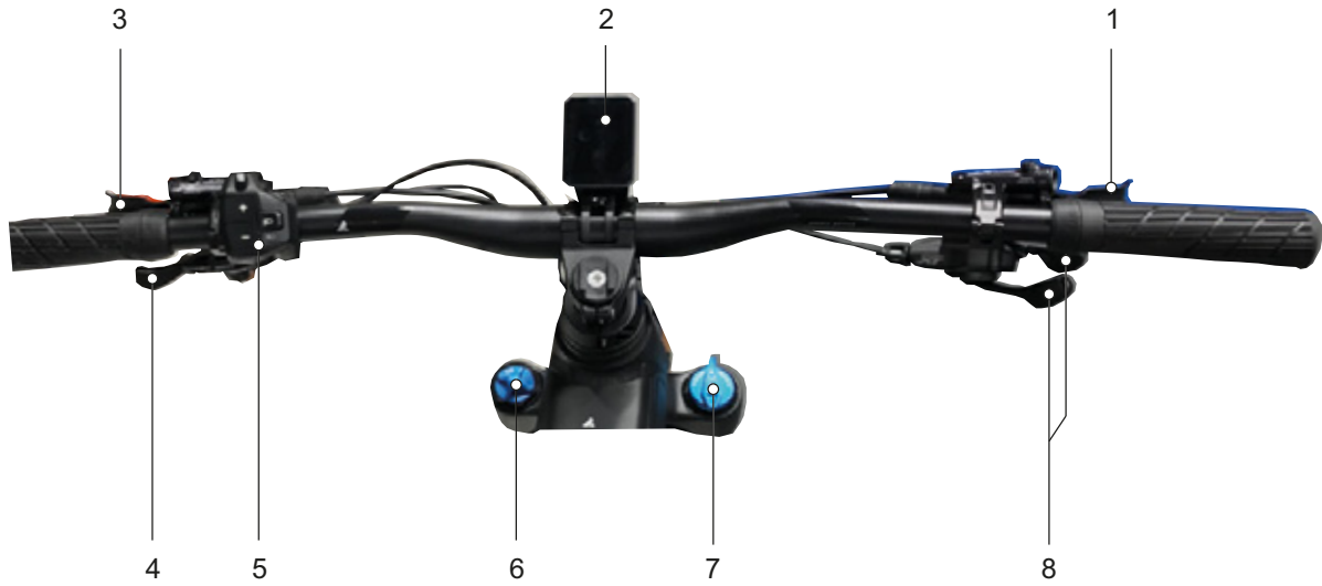
Figura 35: Vista detallada del manillar con ordenador de a bordo SHIMANO SC-E800, ejemplo
