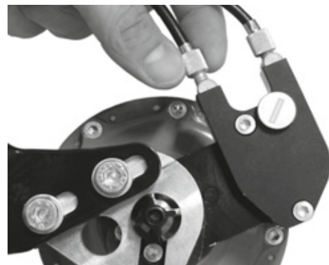
Figura 144: Las versiones de bujes Rohloff con activación de cambio externa tienen los dispositivos de ajuste de tensión en la caja de cables que se encuentra en el lado izquierdo
