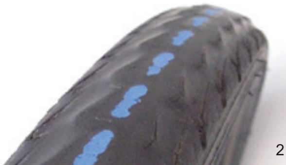
Figura 138: Cubierta sin perfil que aún puede utilizarse (1); cubierta con protección contra pinchazos visible que tiene que cambiarse (2)
