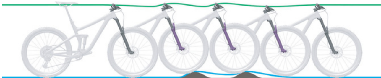
Figura 215: Descompresión demasiado lenta de la horquilla de suspensión
