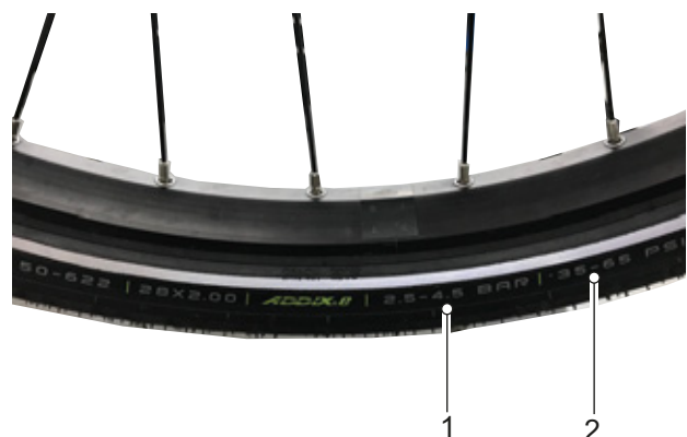
Figura 137: Presión de inflado en bar (1) y psi (2)
