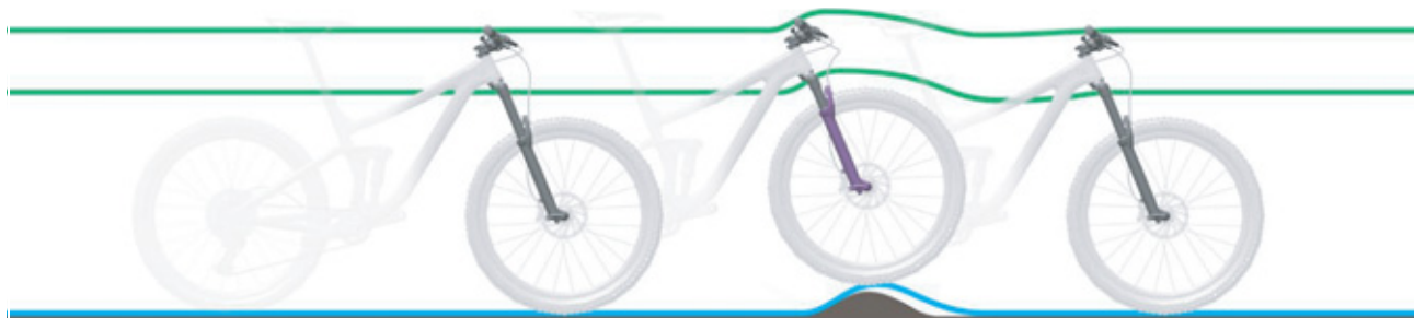
Figura 219: Amortiguación de la horquilla de suspensión demasiado dura en caso de irregularidades
