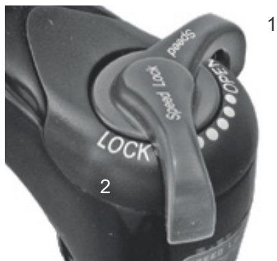
Illustration 78 : Dispositif de réglage de la compression Suntour avec les positions OPEN (1) et LOCK (2)
