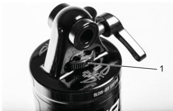
Illustration 60 : Molette de réglage de la détente Suntour (1) sur l'amortisseur arrière
