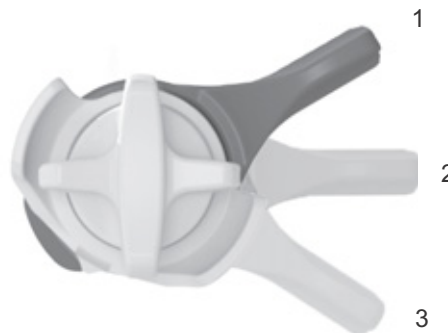
Illustration 76 : Dispositif de réglage de la compression FOX sur l'amortisseur arrière avec les positions OUVERT (1), MOYEN (2) et DUR (3)
