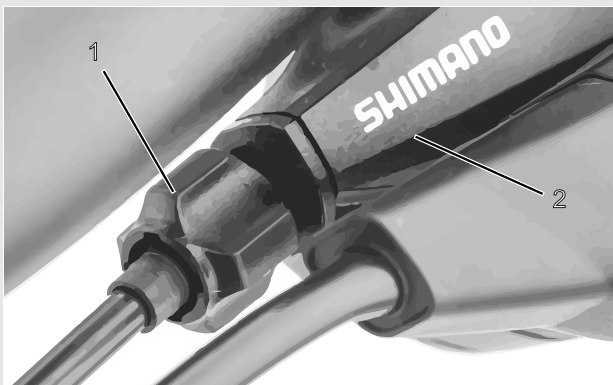
Illustration 84 : Douille de réglage (1) du changement de vitesse à un câble actionné par câble avec boîtier de manette de vitesse (2), exemple
