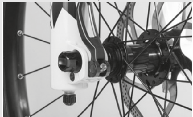
Illustration 82 : Régler la force de serrage de l'attache rapide
