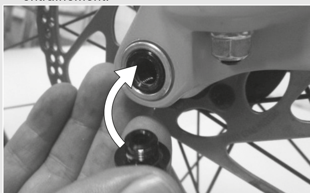
Illustration 26 : Enfoncer le levier d'attache rapide dans l'axe
