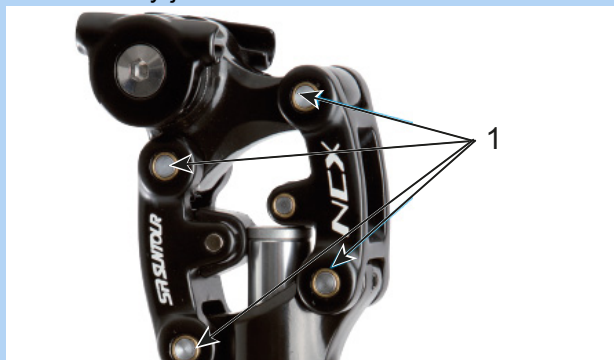
Obr. 157: Mazací body odpružené sedlovky Suntour SR
