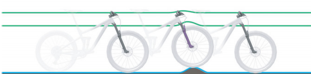
Obr. 128: Optimální chování při jízdě u nerovností
