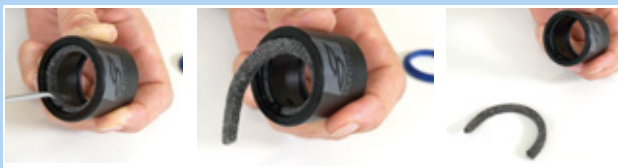
Obr. 204: Odstranění plstěného kroužku
