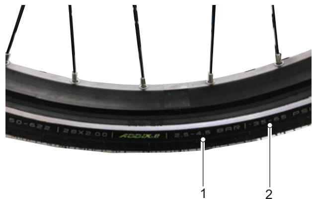
Obr. 144: Plnicí tlak v barech (1) a psi (2)
