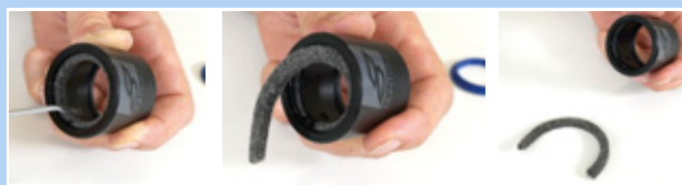
Obr. 169: Odstranění plstěného kroužku
