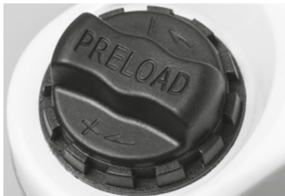
Illustration 58 : Molette de réglage de la course de suspension négative sur la couronne de la fourche de suspension
