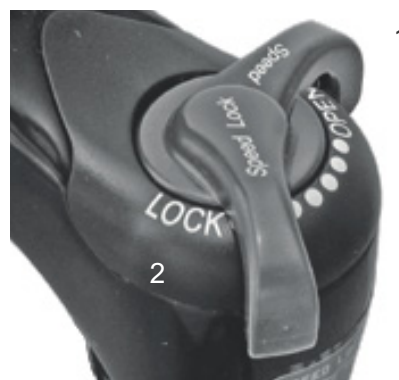
Illustration 76 : Dispositif de réglage de la compression Suntour avec les positions OPEN (1) et LOCK (2)
