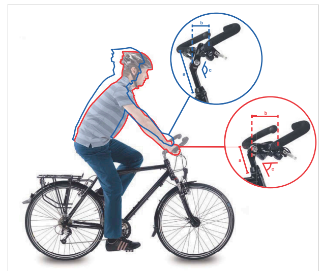
66. ábra: Városi kerékpár (kék) és túrakerékpár (piros) a szög változtatásával
