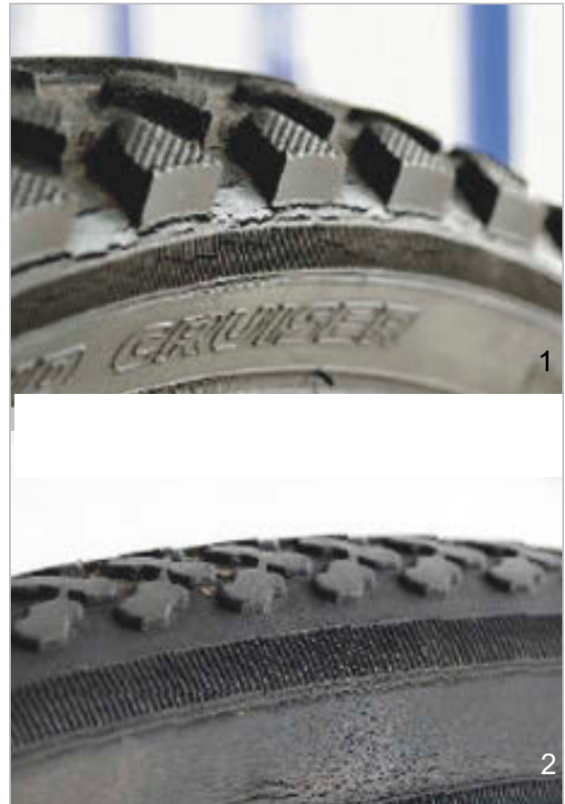
103. ábra: Példák kifáradási repedésekre (1) és öregedési repedésekre (2)
