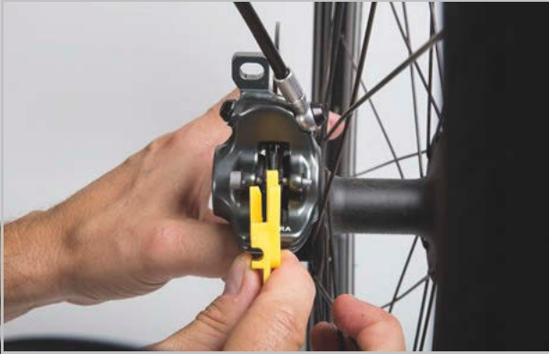
104. ábra: Fékbetét ellenőrzése beépített állapotban a szállítási rögzítés segítségével
