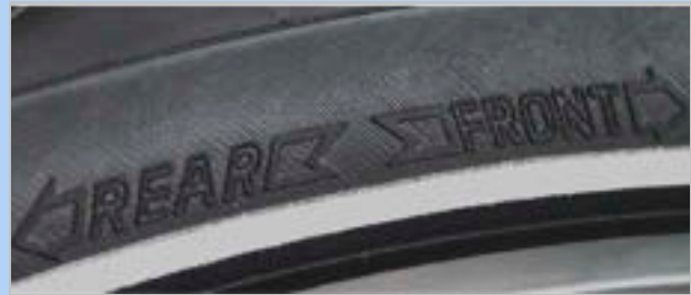
41. ábra: Futásirányjelző nyíl MTB gumiabroncsokon
