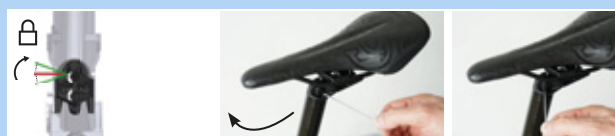
Obr. 205: Zavření nastavení výšky
