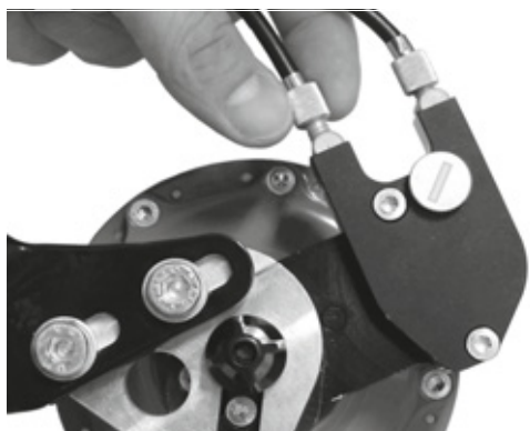
Obr. 161: Náboje Rohloff s externím ovládním řazení mají seřizovače napnutí na lanovodu, který je umístěn na levé straně
