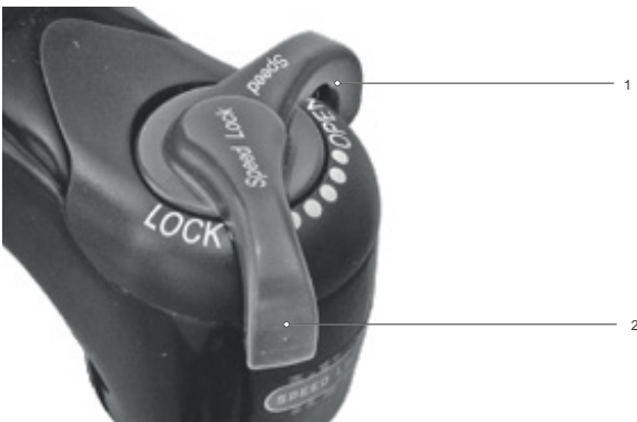
Obr. 235: Tvrdé nastavení nastavovacího šroubu komprese
