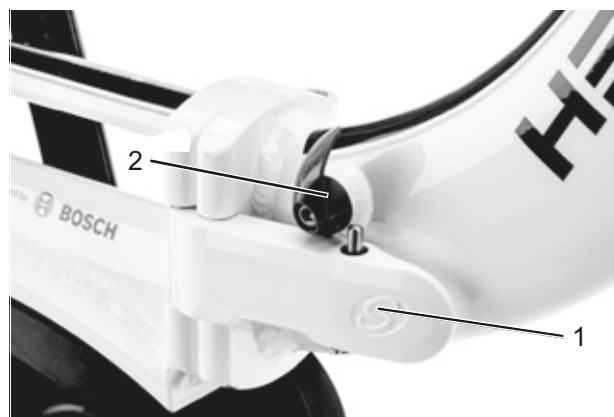
Obr. 148: Zavřená (1) a otevřená (2) pojistná páka rámu
