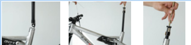
Obr. 196: Upevnění krytu ventilku kazety
