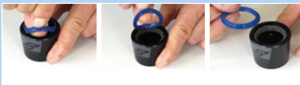
Obr. 213: Vytažení stíracího kroužku
