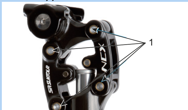
Obr. 167: Mazací body odpružené sedlovky Suntour SR
