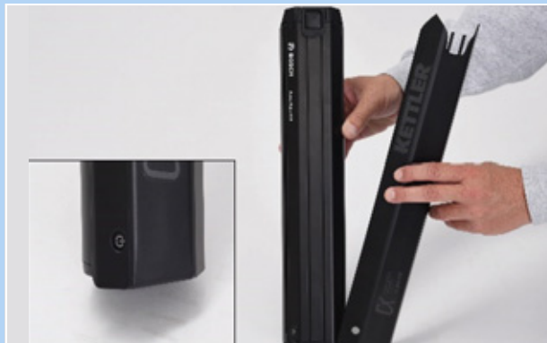
Obr. 59: Nasunutí krytu na akumulátor
