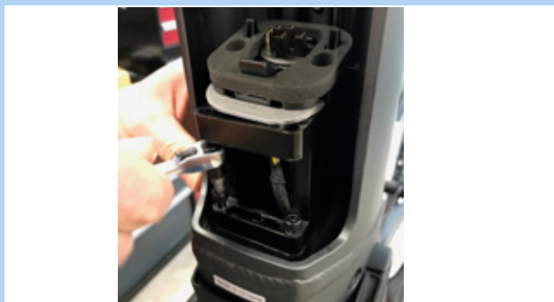
Obr. 52: Odstranění 6hranných šroubů 4 mm
