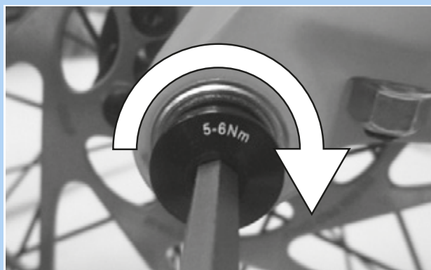
Obr. 69: Utažení pojistného šroubu
