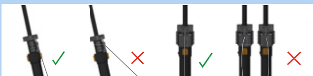
Obr. 195: Správné a nesprávné vedení bovdenů
