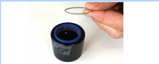
Obr. 212: Vyjmutí pružné podložky
