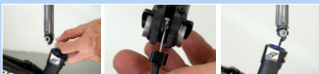
Obr. 226: Zavedení a zasunutí sedlovky
